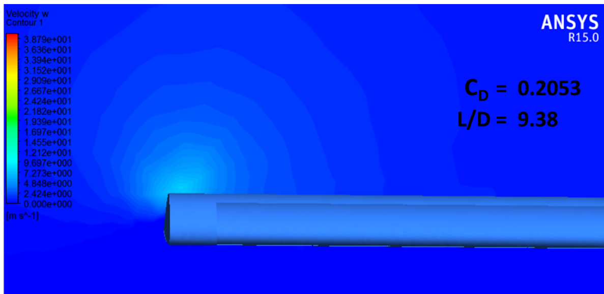
Figura 26. Comportamiento del aire en dirección (Z) sobre la punta de la envergadura SIN "Hoerner wingtip"
