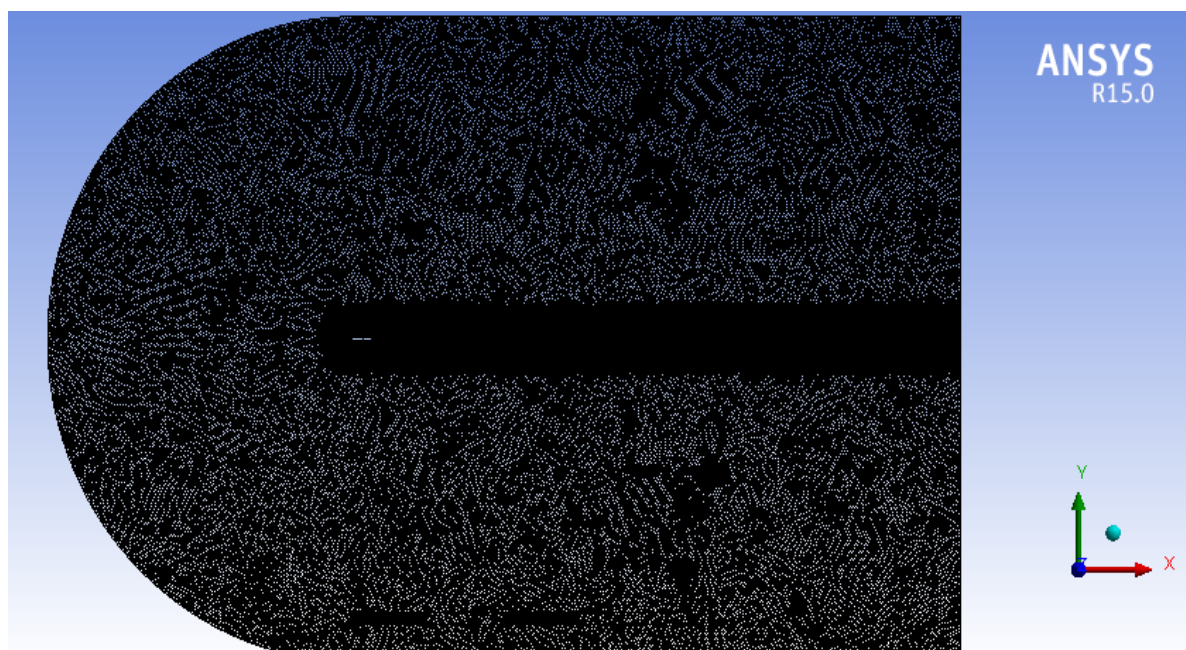
Figura 13. Discretización del de campo de flujo (Mallado = 900 000 elementos con un tamaño aproximado de 6mm en la zona cercana al perfil)
