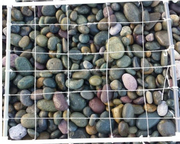
Figura 11. Cuadrante para caracterizar el sedimento de playas de cantos rodados.
