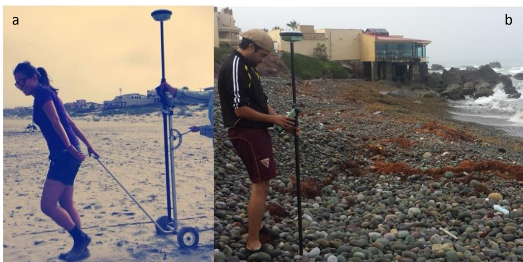
Figura 13. Levantamiento topográfico por medio de dGPS diferencial: (a) de forma continua con el dGPS montado sobre un eje móvil en la playa arenosa (Playa Hermosa); y (b) de forma puntual en la playa de canto rodado (Granada Cove).
