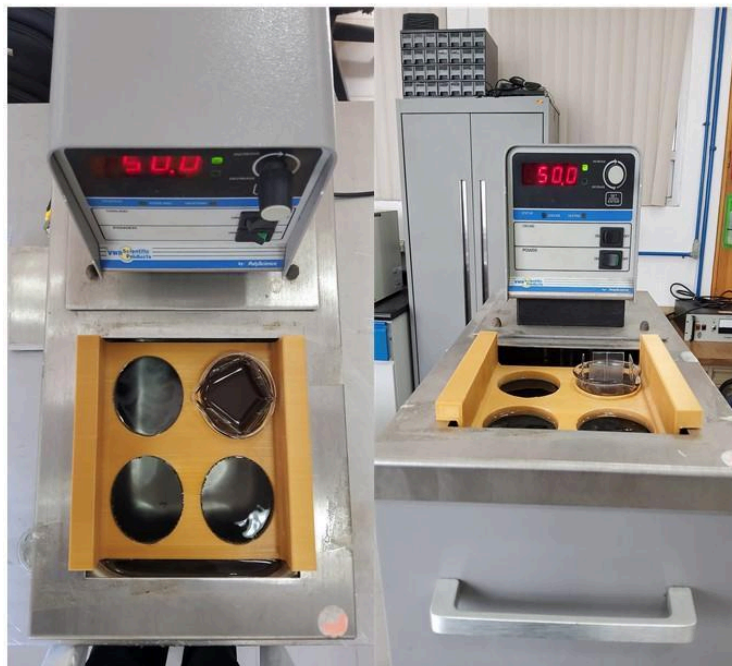
Figura 14.- Fotografía del sistema y arreglo del baño químico.
