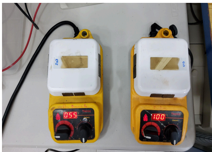
Figura 15.- Tratamiento térmico de películas delgadas de CuS.
