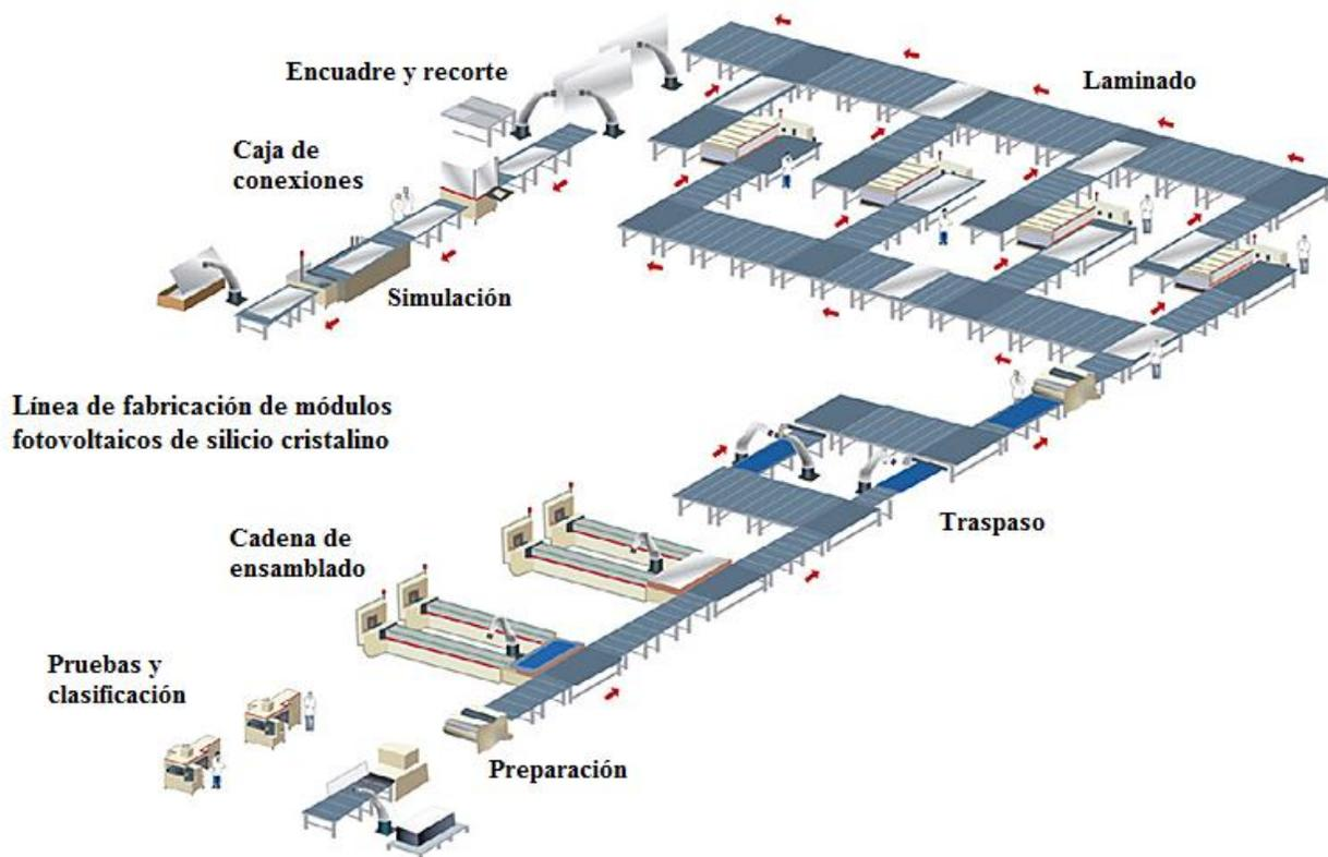
**Figura 12** – Procesos Back-End de una típica línea de fabricación de células solares de silicio cristalino. El proceso de fabricación comienza con la preparación y termina con la simulación (Yaskawa, 2010).
