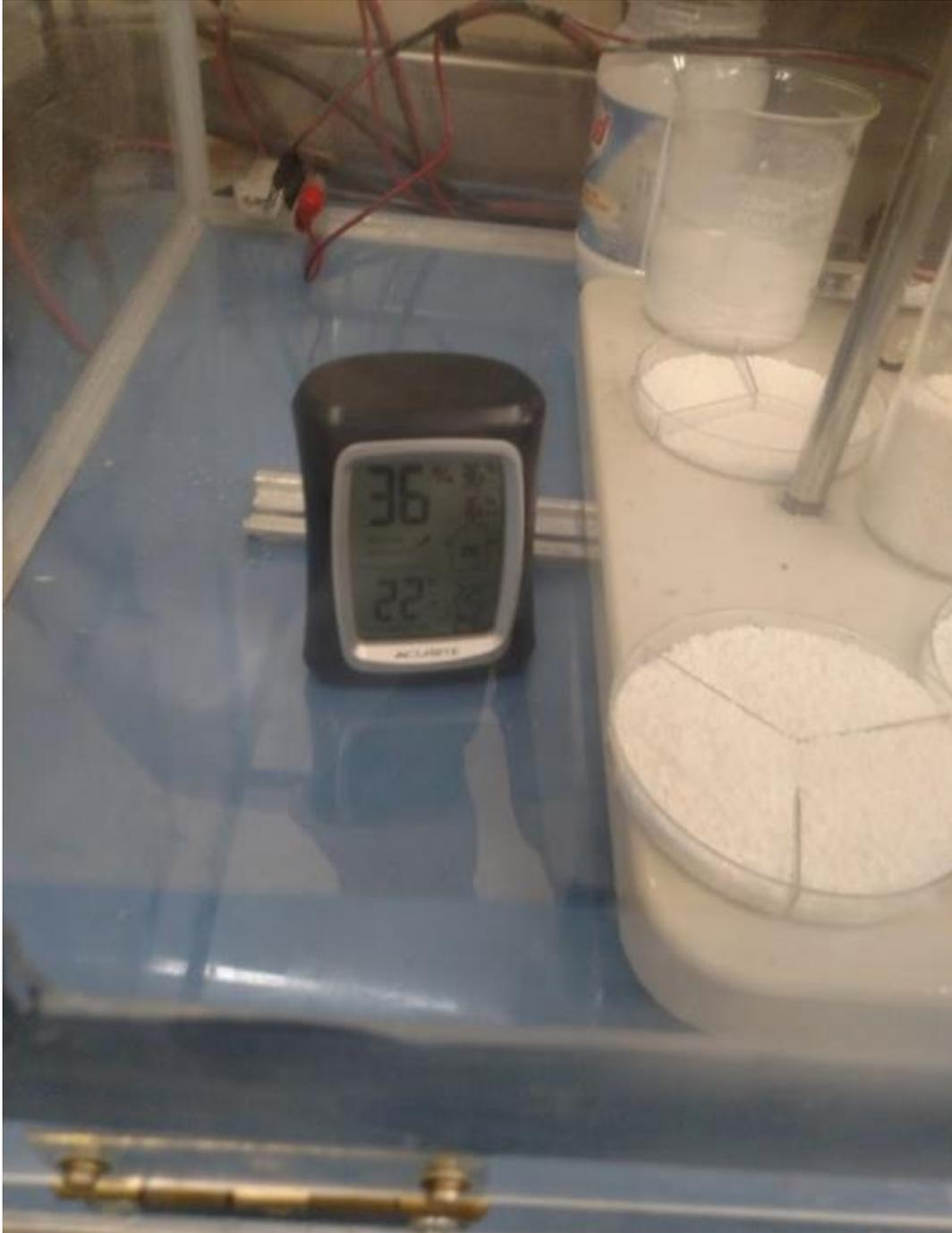
**Figura 26** – Medidor de condiciones del ambiente dentro de la cámara donde ocurre el proceso de electrohilado.
