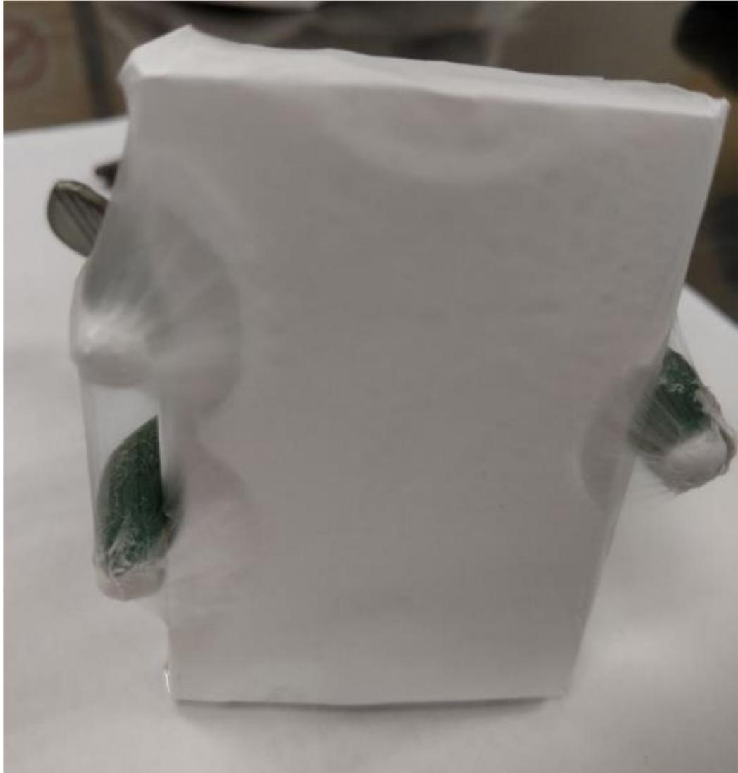
**Figura 19** – Aspecto de iteraciones de concentración en nanofibras electrohiladas depositadas en el colector.
