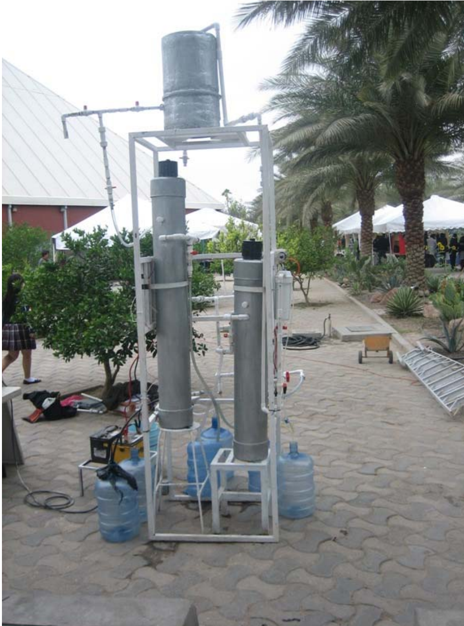
Figura 46. Filtros granulares en tanques de PVC
