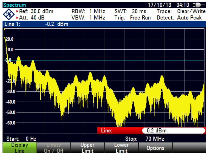
Figura 5.11: Espectro generado por la codificación convolucional K = 6 ( V_1 = [10111] y V_2 = [11001] ) con generador de datos de 4 registros.
