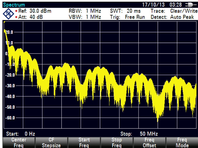
Figura 5.9: Espectro generado por la codificación convolucional de los datos generados en la fuente.
