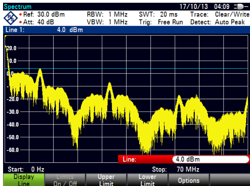
Figura 5.11: Espectro generado por la codificación convolucional K = 6 ( V_1 = [10111] y V_2 = [11001] ) con generador de datos de 4 registros.
