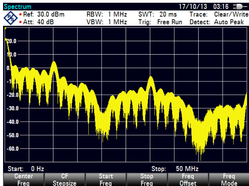
Figura 5.9: Espectro generado por la codificación convolucional de los datos generados en la fuente.
