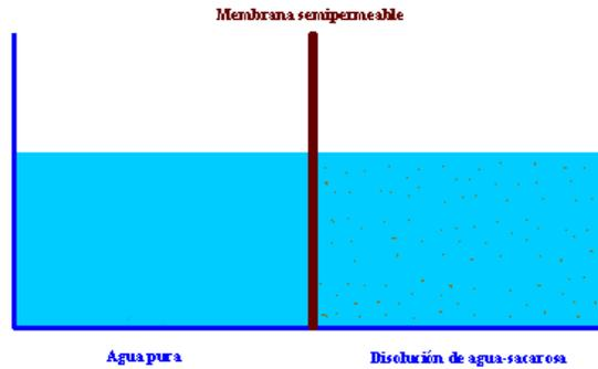
A medida que el agua va pasando al lado de mayor concentración, éste se va diluyendo, y al mismo tiempo va aumentando la presión dentro de él. Llega un momento que la diferencia de concentraciones no es suficiente para seguir arrastrando más agua y el proceso osmótico se detiene.
