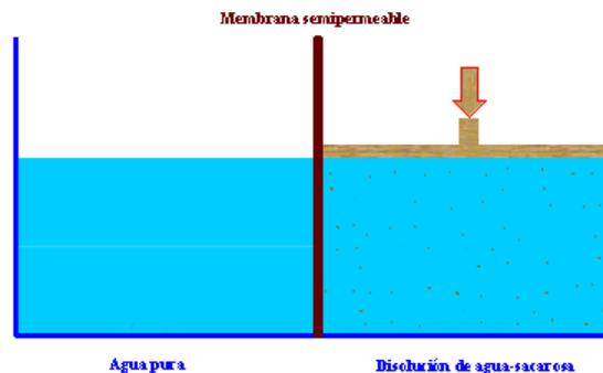
El agua comienza a pasar a través de la membrana desde la disolución concentrada al recipiente con agua pura. Este proceso permite obtener agua con un elevado grado de pureza, puesto que sólo pueden pasar a través de la membrana moléculas de pequeño tamaño (molécula de agua) y no sales o sustancias orgánicas de mayor tamaño.
