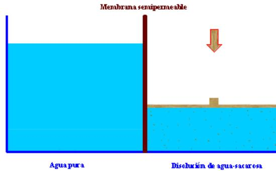
En términos simples, ósmosis inversa es la filtración bajo presión a través de una membrana cuyos poros son pequeños. La membrana de ósmosis está diseñada de manera que impide el paso de sales inorgánicas, bacterias, virus, compuestos orgánicos, obteniéndose un agua de una excelente calidad para el consumo.
