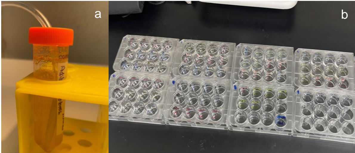
Figura 16. Sistema para eclosionar Artemia salina (a) y placas para ensayos (b). Se muestra el sistema para eclosión de Artemia salina y las placas multipozos para evaluar sobrevivencia a las 12, 24 y 48 hrs.
