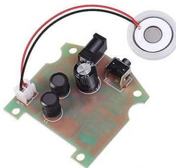
Figura 7.14. Componente piezoeléctrico y su placa de control utilizados para el desarrollo de ReminiScentia.
