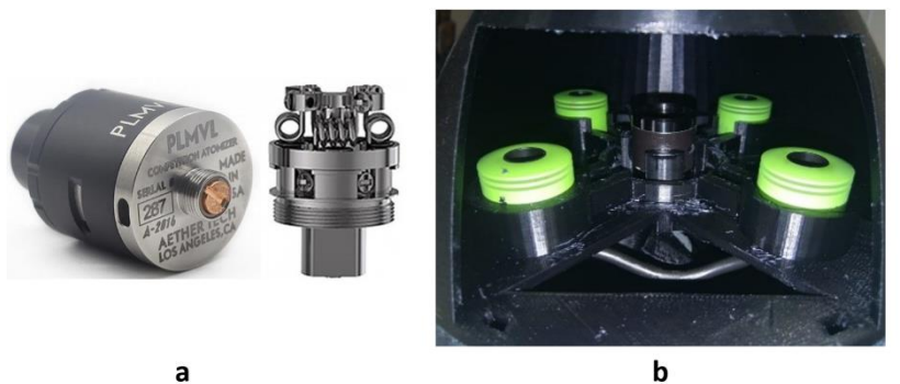
Figura 7.8. a) Uno de los claromizadores utilizados en la construcción de ReminiScencia. b) Montaje de los 5 claromizadores en ReminiScencia.
