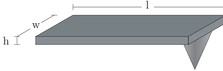
Figura 1.1: Dimensiones generales del cuerpo de un voladizo
