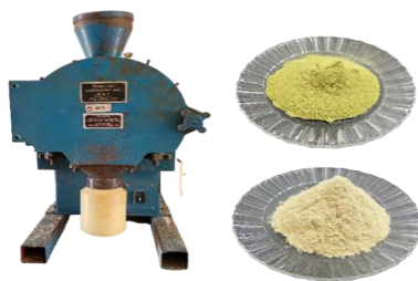
Figura 10. Molino de martillo oscilante y residuos de palma molidos.
