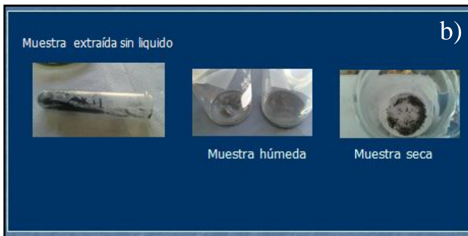
Figura 13. a) Ruta solvotérmica en fotografías de la síntesis de partículas cristalinas de \text{TeO}_2 . b) Muestras sintetizadas.
