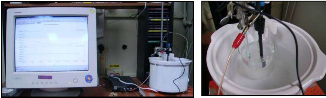
Figura 3.8 Potenciostato "Gamry" modelo FAS-1 PC4 utilizado para medir la polarización de la celda galvánica.
