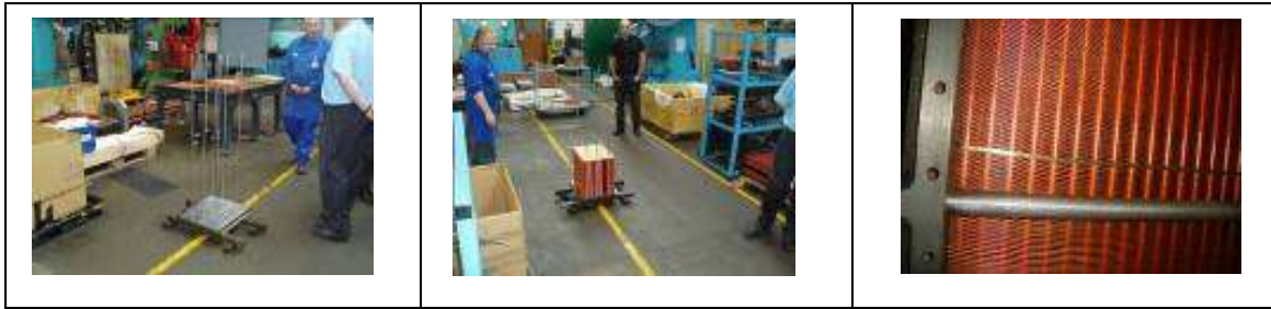
Figura 2.6 Fabricación del cuerpo núcleo. Se puede observar las aletas de cobre insertadas en tubos de cobre, envueltos en una coraza de acero al carbono
