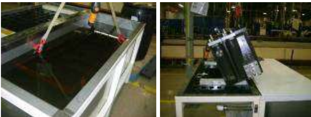
Figura 2.11 Proceso de inmersión del intercambiador de calor en el aceite desplazador de humedad.
