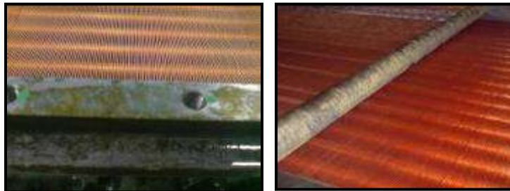
FIGURA 2. Placas laterales y tubos de acero, 24 minutos después de sumergir la unidad en agua de ósmosis inversa, el cobre se muestra intacto.
