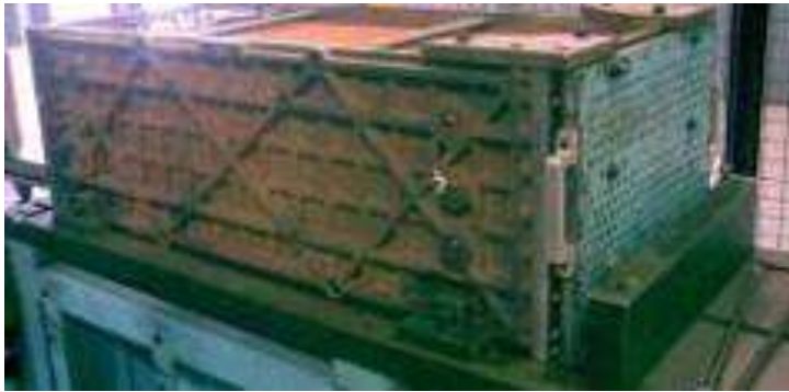
Figura 2.10 Pieza CAT 175 que presentó corrosión en las placas laterales de acero tres semanas después de ser lavada.
