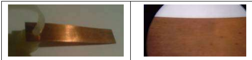
22. Placas de cobre expuestas en agua proveniente del sistema de ósmosis inversa después de 168 horas de exposición.
