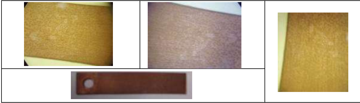
7. Placas de cobre después de 72 horas de exposición en la solución jabonosa al 7.5%.
