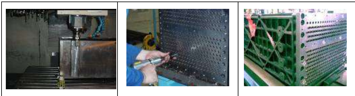
Figura 2.7 Proceso de expansión de tubos de cobre para evitar fugas entre éstos y la placa de acero.
