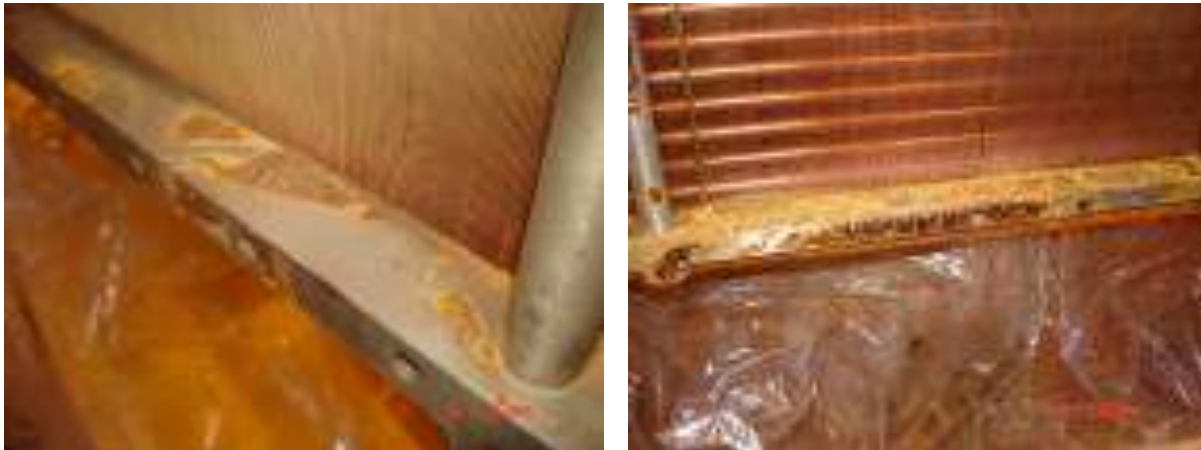
Figura 2.9 Piezas que presentaron corrosión en las placas y tubos laterales de acero después de un mes de haber sido enviadas al cliente.
