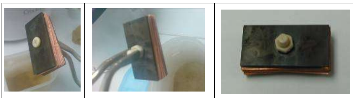
Figura 4.5. Pieza después de 5 días de exposición en agua de enjuague, sin inhibidores de corrosión.
