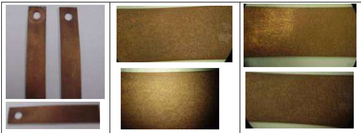
8. Placas de cobre después de 7 días de exposición en la solución jabonosa al 7.5%. Podemos observar la opacidad de la superficie, las manchas que muestra la superficie, es consecuencia de la misma protección del cobre al medio.
