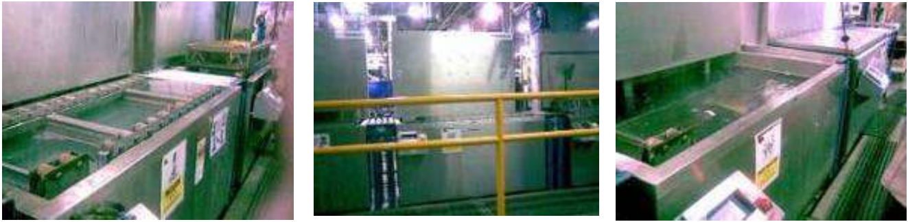
Figura 2.14. Tinas del proceso de limpieza: jabón, enjuague y cámara de secado.
