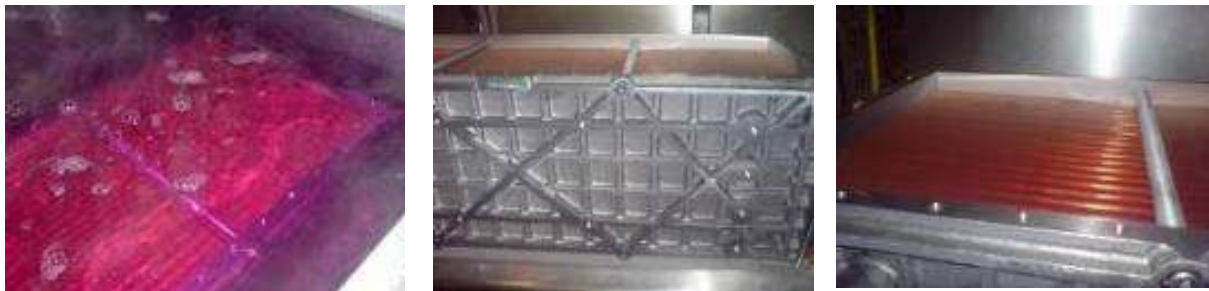
26. Intercambiador de calor, sumergido en tina de enjuague, con la aplicación de inhibidores de corrosión.
