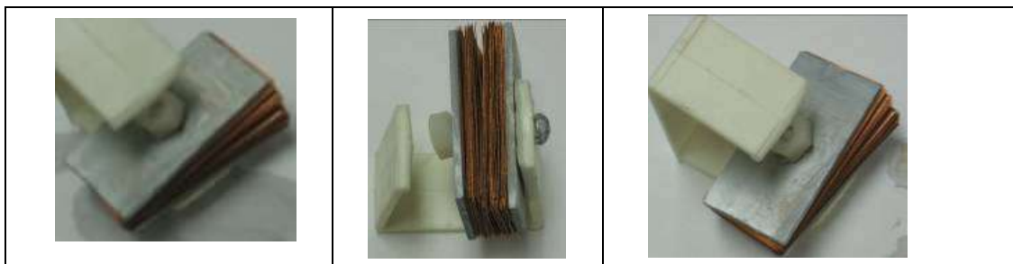
Figura 4.3 Pieza después de 5 días de exposición, en jabón potásico al 7%, sin inhibidores de corrosión.
