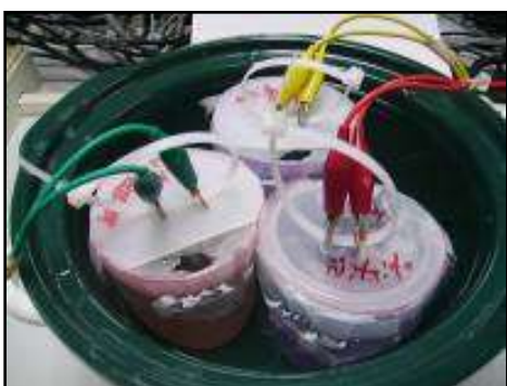
Figura 3.6. Izquierda. Arreglo de las placas disimilares, conectadas eléctricamente, para inducir el par galvánico. Derecha. Voltímetro, aparato para medir el potencial del par galvánico.
