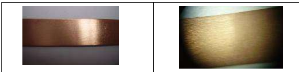
20. Placas de cobre expuestas en agua proveniente del sistema de ósmosis inversa después de 24 horas de exposición
