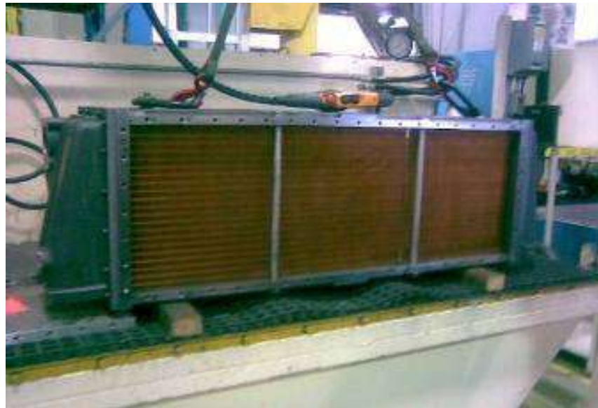
Figura 2.4 Enfriador de aceite de Honeywell CAT 175, para un generador de energía para maquinaria industrial manufacturada por Caterpillar.
