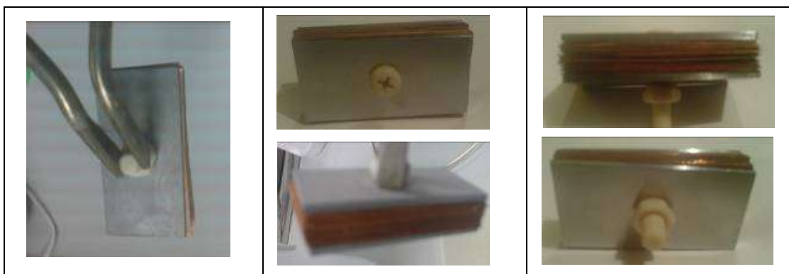
Figura 4.6 Pieza después de 5 días de exposición en agua de enjuague, con la adición de molibdato y nitrito de sodio.
