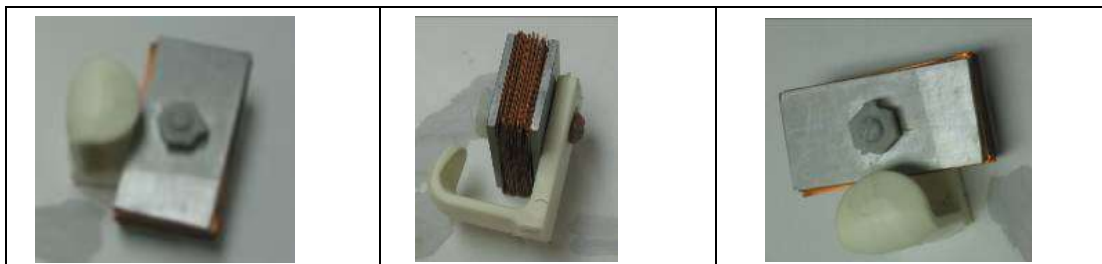
Figura 4.4 Pieza después de 5 días de exposición en jabón potásico al 7%, con la adición de molibdato y nitrito de sodio como inhibidores de corrosión.
