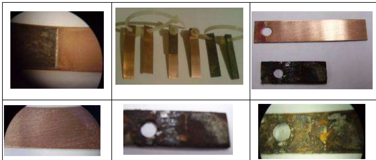
23. Placas de cobre y acero unidas y expuestas en agua proveniente del sistema de ósmosis inversa después de 168 horas de exposición.
