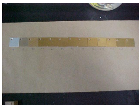
Figura 4.5. Muestras preparadas para determinar cantidad de cromo en el recubrimiento.
