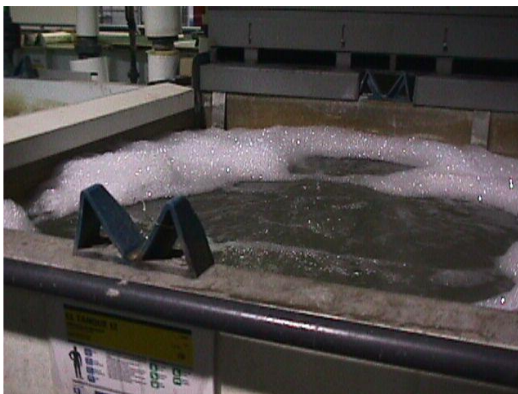
Figura 2.2. Detalle de un baño de limpieza alcalina previo al proceso de cromatizado.
