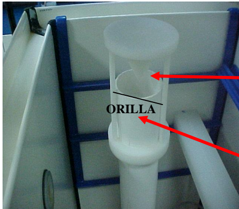
Figura 3.4. Aspersor. La parte de abajo del cono, debe estar al nivel de la orilla del cilindro.
