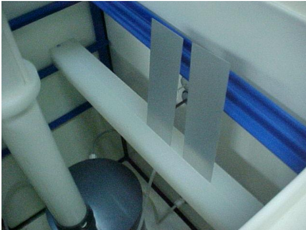
Figura 3.2. Los paneles de ensayo se colocaron en la ranura de la barra de polipropileno, con una pendiente de 6 grados con respecto a la vertical.
