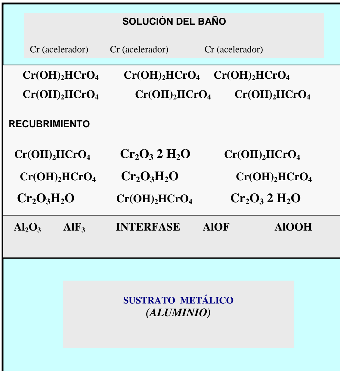
Figura 2.1. Corte de sección transversal de la película por conversión química de cromo - cromato sobre una superficie de aluminio.
