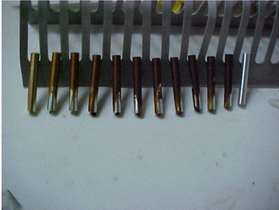
Figura 4.9. Muestras preparadas para ensayos de espectroscopia de impedancia electroquímica (EIS).
