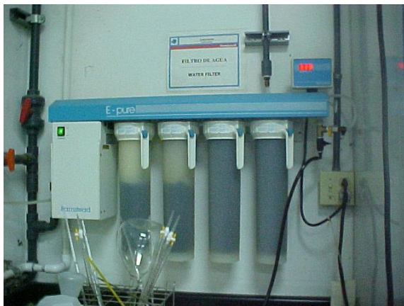
Figura 3.1. Filtro para agua desionizada tipo IV ASTM D 1193. Suministra agua DI a la cámara salina.
