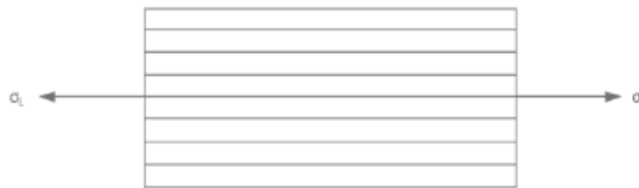
Figura 19. Condición longitudinal de carga de un material compuesto
