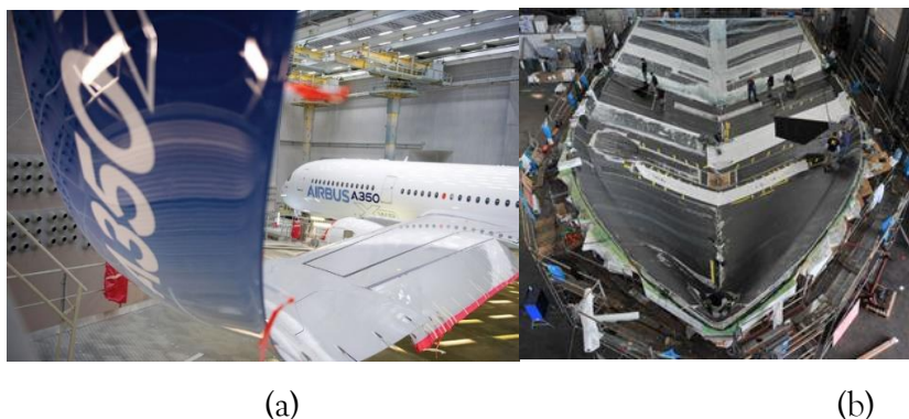
Figura 29: Ejemplos de uso de fibra multidireccional. (a) Ala de un Airbus a350. (b) Casco producido utilizando el proceso manual por deposición de capas con compresión de vacío.
