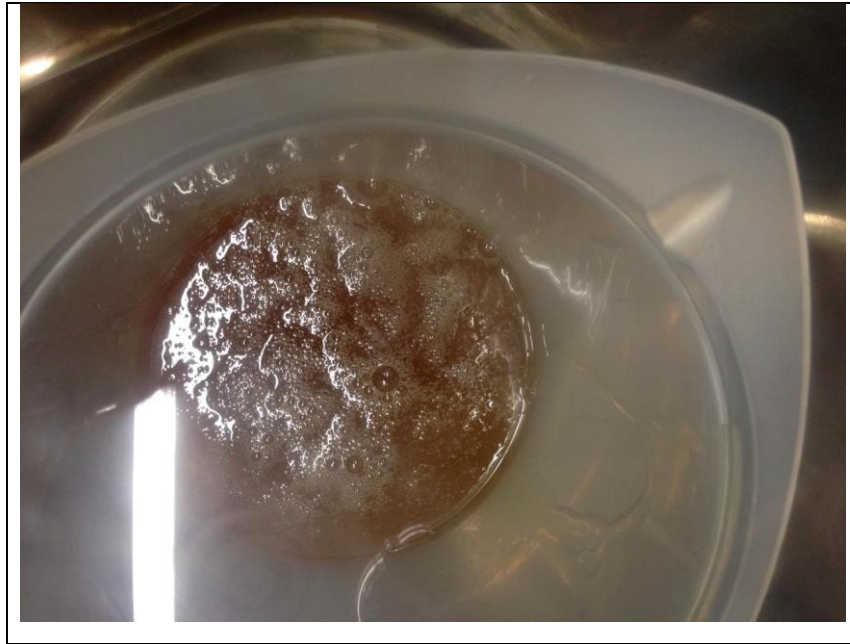
Figura 37. Proceso de eliminación de aire en mezcla de resina y catalizador.
