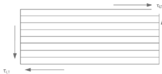
Figura 21. Condición de carga en cortante de un material compuesto
