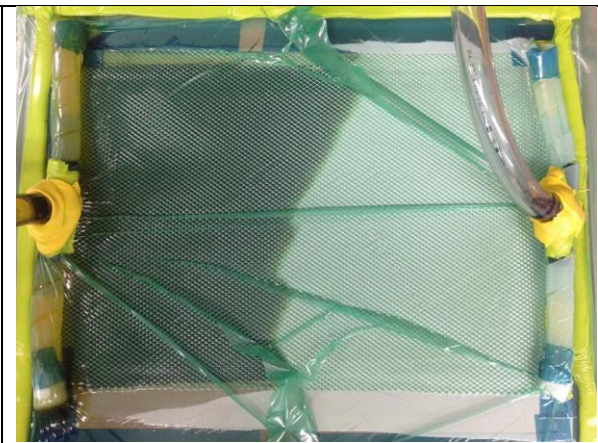
Figura 38B. Finalizado del RTM.
