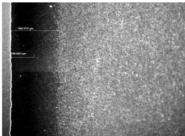
Figura 4-30 Profundidad de Capa para muestra #29 (4 h, 980 °C, 80/20) - Sulfato de Amonio.
