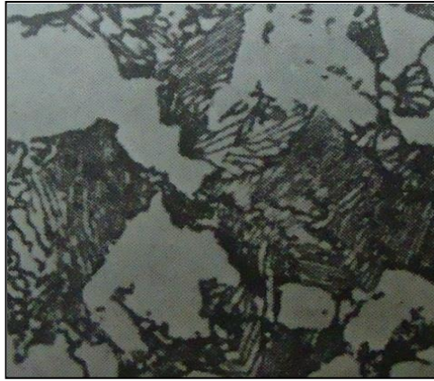
Figura 1-7. Cristales de ferrita y perlita en un acero de 0.35% de carbono recocido. Imagen obtenida a 750 aumentos.
