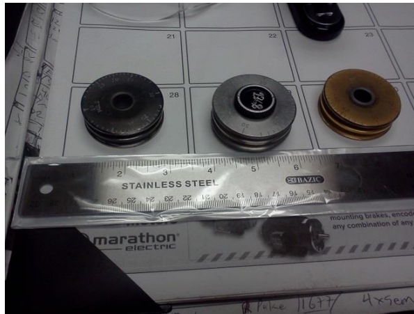
Figura 3-8. Thickness Gage para medir espesor de porcelana.
