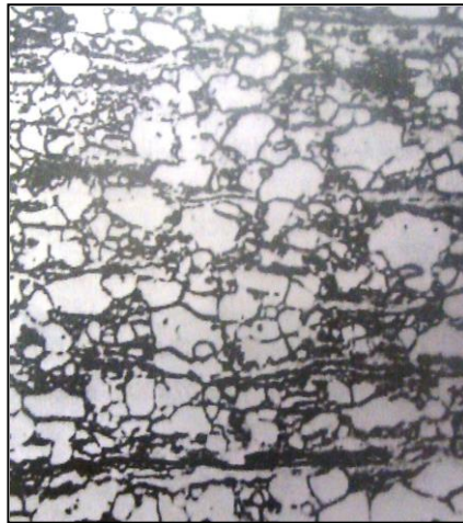
Figura 2-6 Acero con 0.10% de C recocido a 1025 °F (552 °C). Los granos de ferrita se reforman en su mayoría a su estado original. Imagen a 1000 aumentos.
