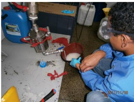
**Figura 3.22** Lavado del biodiesel, con agua caliente.
