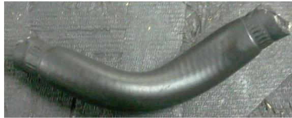
**Figura 3.5** Manguera del sistema de alimentación deformada.
