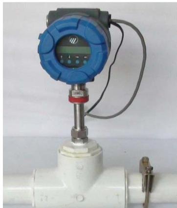
**Figura 3.27** Medidor de flujo de aire Thermal TA2
