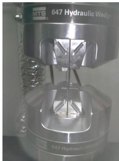
**Figura 3.9** Equipo de pruebas universal electromecánico MTS modelo Insight 100 extended length.
