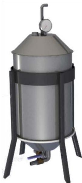
Figura 3. Vista isométrica del equipo extractor de aceites esenciales.
