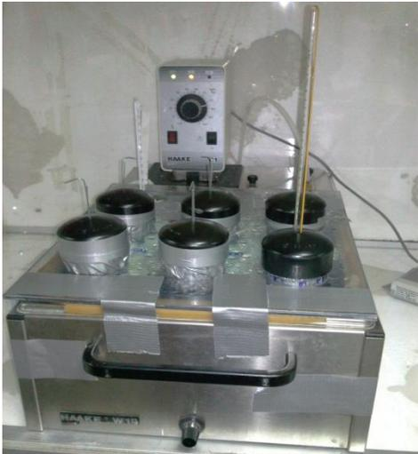
**Figuras 3.8** Muestras de mangueras expuestas a temperaturas 25 °C y 75°C.
