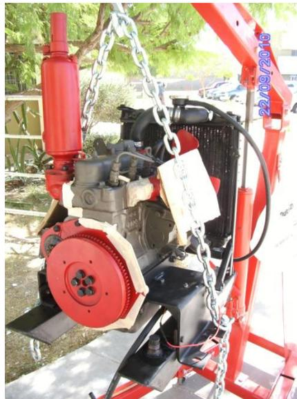
**Figuras 3.13** Motor diesel Kubota D600–B, condiciones finales.
