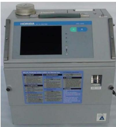
**Figura 3.28** Medidor portátil de NO<sub>x</sub> EXA 240CL
