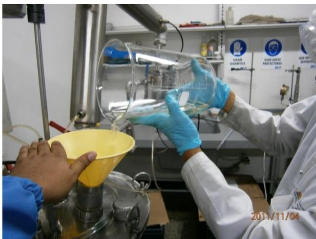
**Figura 3.19** Agregando catalizador para llevar a cabo la reacción de transesterificación.
