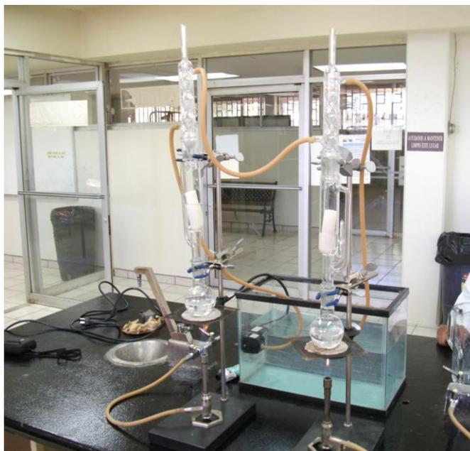
**Figura 3.17** Sistema de extracción Soxhlet, montado en los laboratorios del Tecnológico de Mexicali.
