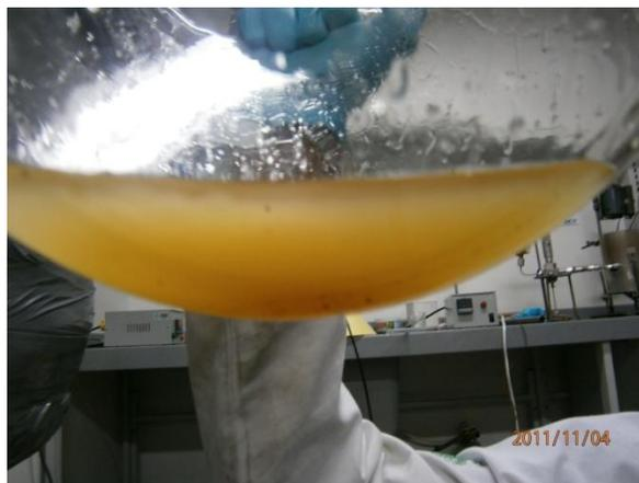
**Figura 3.20** Muestra de metanol con biodiesel extraído del reactor.
