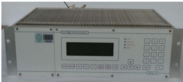
**Figura 3.30** Medidor de THC por ionización de llama.
