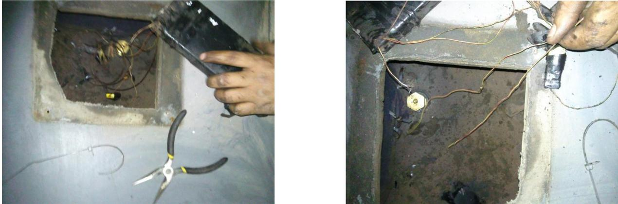
**Figura 3.10** Instalación de termopares y sistema de adquisición de datos.
