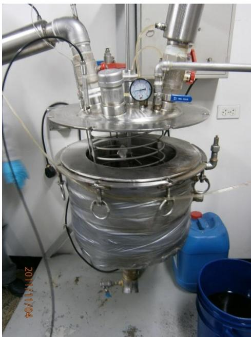
**Figura 3.18** Reactor utilizado para hacer biodiesel.
