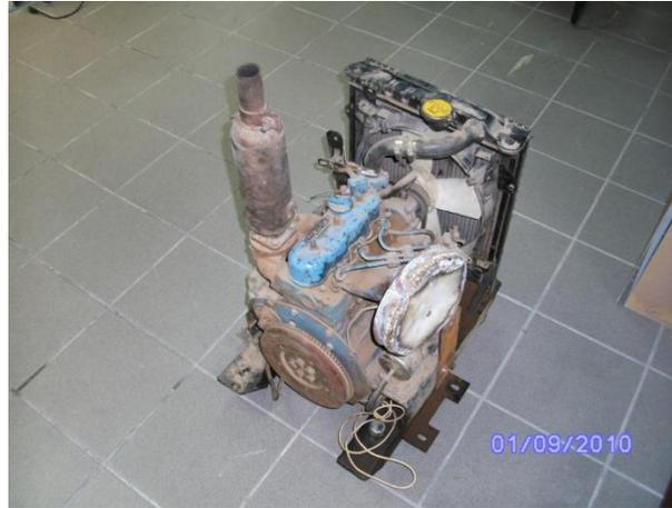
**Figuras 3.12** Motor diesel Kubota D600–B, Condiciones iniciales.
