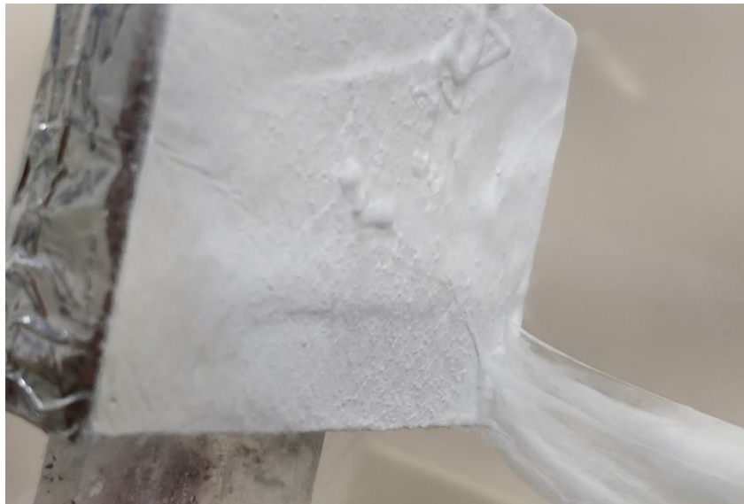
Figura 4. Fibras de quitosano obtenidas mediante la preparación de las muestras PVP/ChS y PVP/ChQ2.
