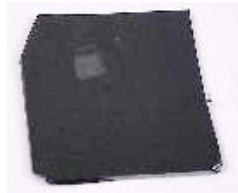
Figura 4-17. Depósito de Si sobre Si tipo p a 100 °C durante 5 min.
