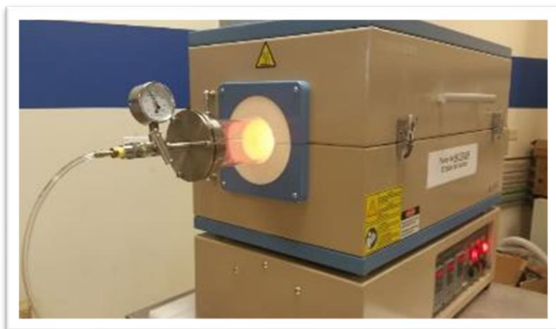
Figura 3-4. Fotografía de horno OTF-1200X de MIT Corporation.
