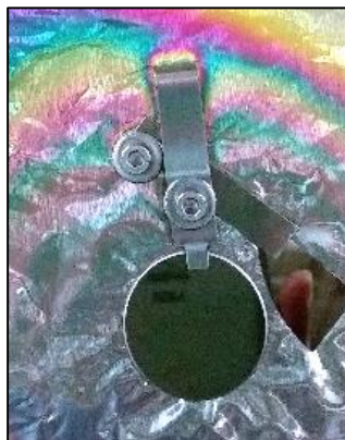
Figura 4-18. Depósitos de Si por sputtering sobre sustrato de cuarzo y silicio, durante 60 min a una temperatura de 350 °C.
