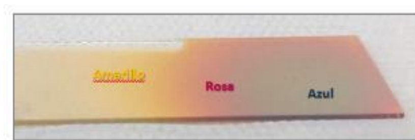
Figura 4-15. Imagen de un depósito de Si sobre vidrio a temperatura ambiente, 120 watts, 5 mTorr y 5 min de depósito.
