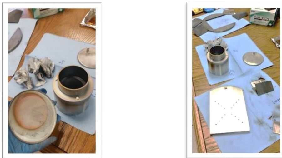
Figura 3-1. Procedimiento de limpieza a las partes internas de la cámara de sputtering.
