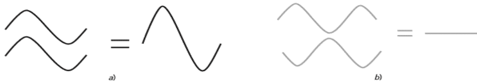
Figura 2-25. Patrones de interferencia para rayos x: a) interferencia constructiva, b) interferencia destructiva.
