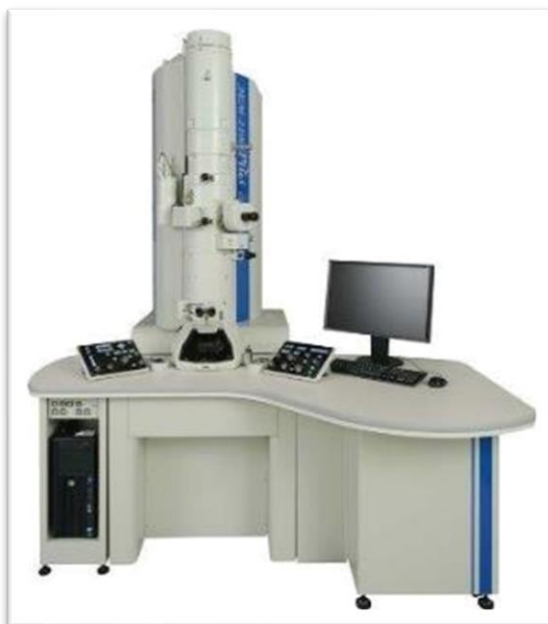
Figura 3-7. TEM modelo JEOL JEM-2100 [85].
