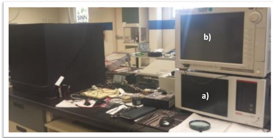
Figura 3-9. Estación de caracterización eléctrica que incluye caseta de mediciones, equipo Keithley 4200-SCS a) y Agilent Technologies B1500A b).
