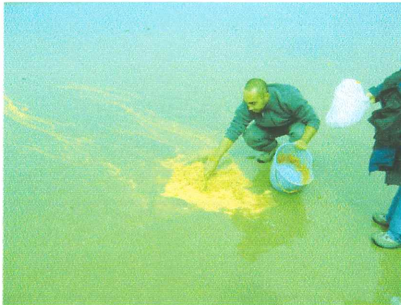
Figura 6: Siembra de los trazadores en la sección central de Playa de la Victoria. Se muestra la siembra en la zona de playa con sedimento que caracteriza dicha playa.
