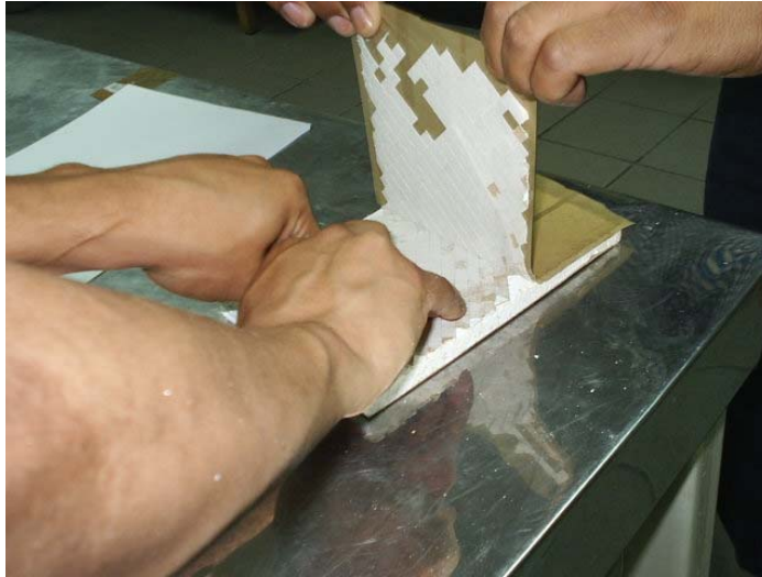
Figura 4.8: Adherencia del recubrimiento
