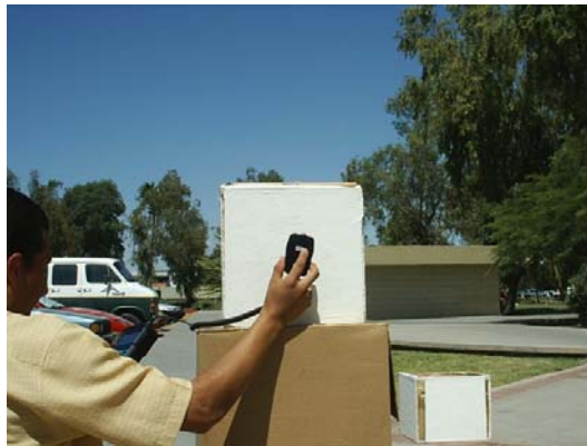
Figura 4.10: pruebas de reflectancia. Orientación este
