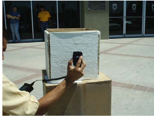
Figura 4.11: Pruebas de reflectancia. Orientación sur
