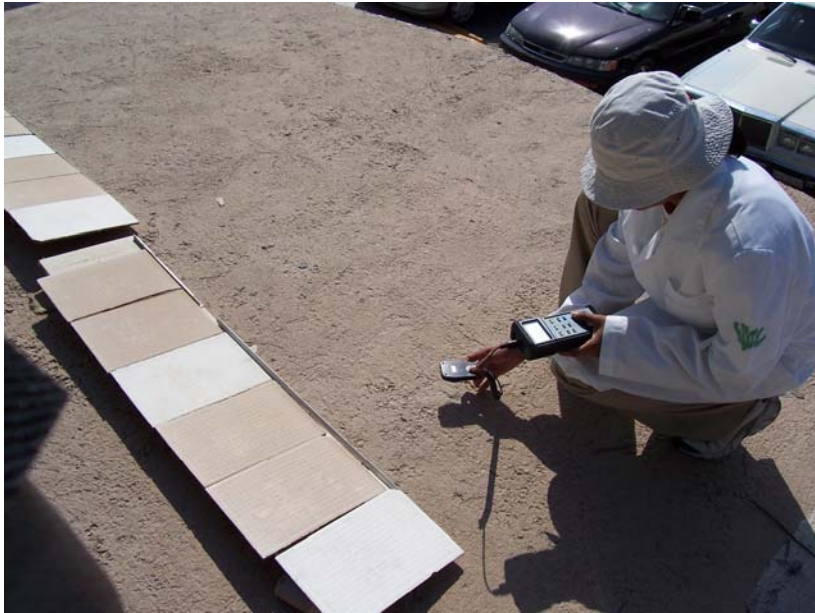
Figura 4.3: Mediciones de iluminación en las muestras de pintura.
