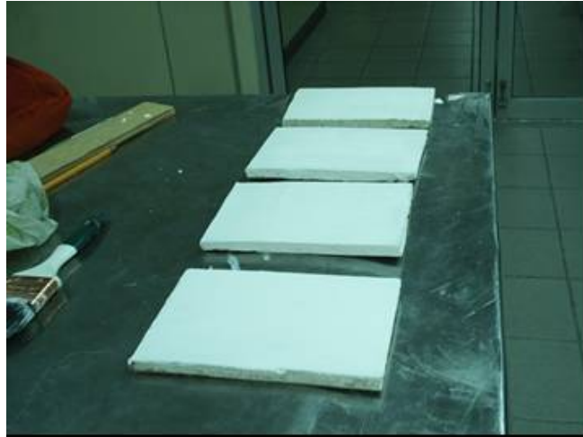
Figura 4.6: Aplicación de cuatro recubrimientos en cartón de yeso
