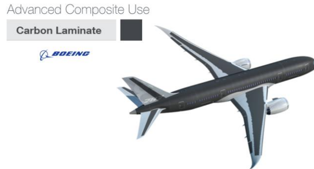
Figura 3-3 Uso de laminado de carbón en Boeing 787 Dreamliner. [84]
