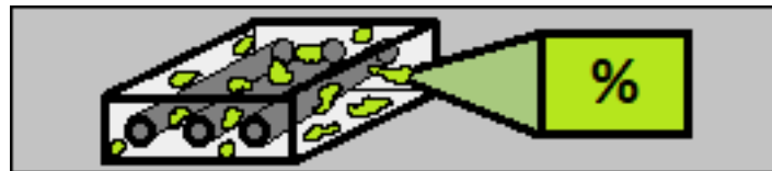
Figura 6–4 Representación del contenido de vacío porcentual en un material compuesto.
