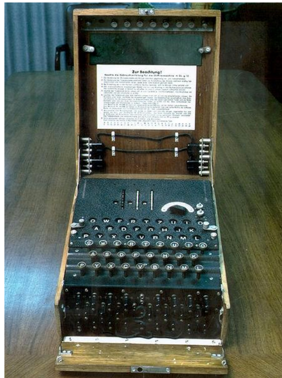
Figura 3.2: Enigma , máquina criptográfica utilizada por los alemanes en 1940.
