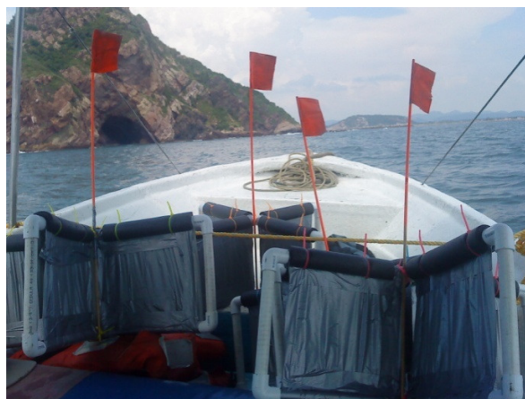
Figura 3. Boyas de Deriva de PVC con GPS integrado.
