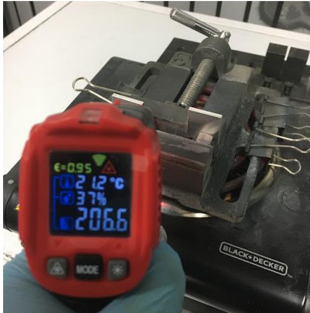
Figura 59. Configuración para posicionar y calentar los sustratos, elaboración propia.
