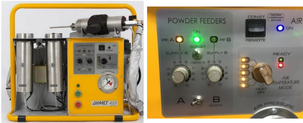
Figura 42. Dymet D423 y panel de control.
