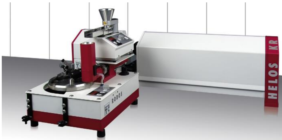
Figura 47. PSD Sympatec Helos/BR-OM, Fuente: Sympatec brochure HELOS [58].
