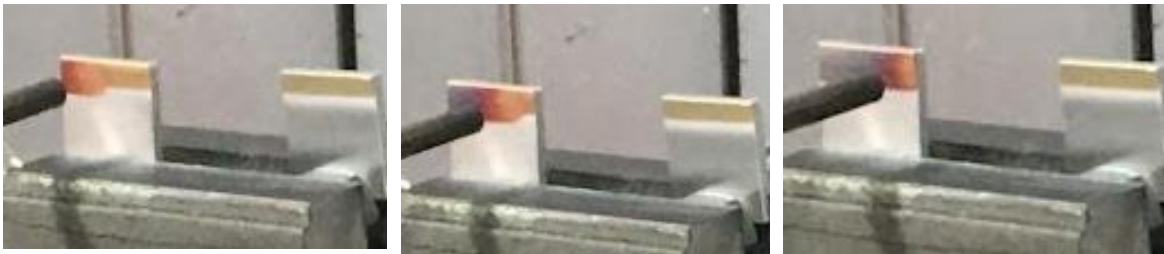
Figura 62. Secuencia de ruta programada del robot KUKA para la formación del recubrimiento, elaboración propia.
