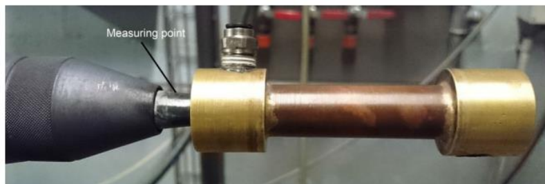
Figura 24. Boquilla de CS con dispositivo de enfriamiento [39].
