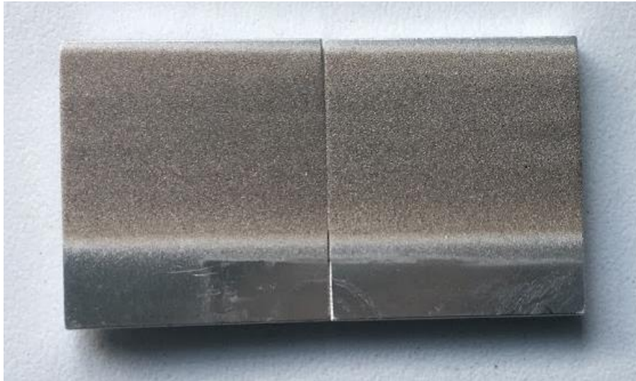
Figura 58. Resultado de la prueba de recubrimiento realizada con el polvo Oerlikon® tamizado, elaboración propia.
