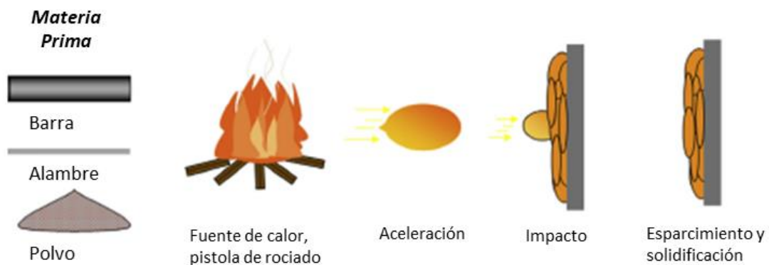
Figura 1. Principio de los procesos de rociado térmico [8].
