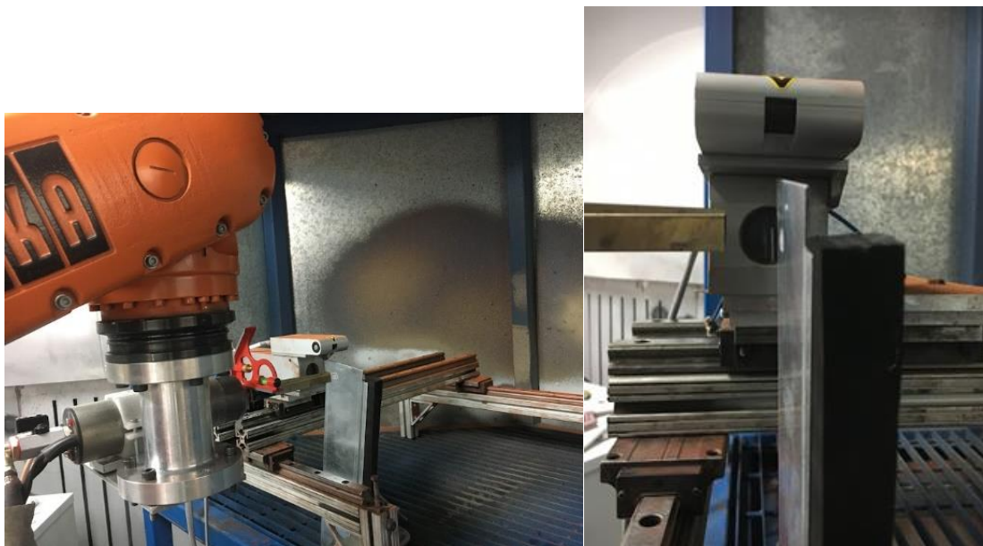
Figura 65. Instalación y configuración del equipo HiWatch para realizar la medición de velocidad de las partículas (izquierda), y vista lateral de la configuración del mismo equipo para la medición de la velocidad de las partículas cerca del sustrato (derecha).
