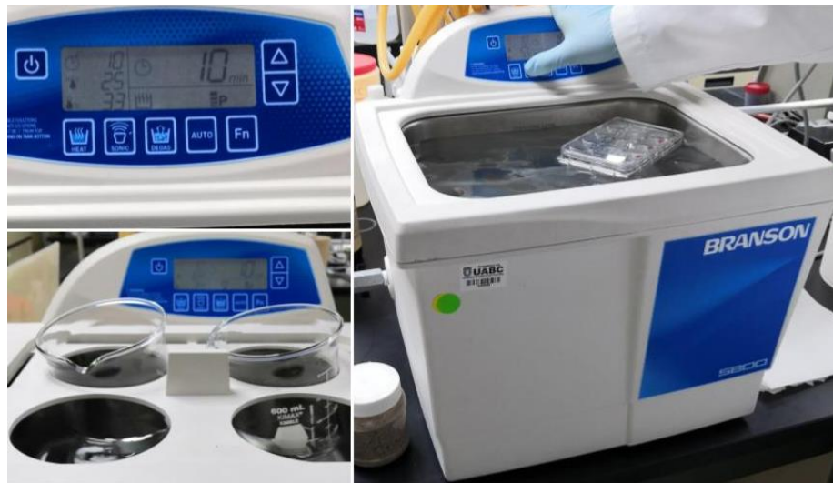
Figura 3. Imágenes captadas durante el baño ultrasónico para la limpieza y desengrase de las muestras.
