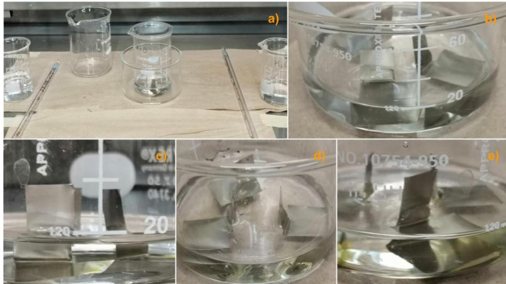
Figura 4. Imágenes del proceso de oxidación química controlada a) vista general del material usado dentro de la campana de extracción, b) vista superior de las muestras a pocos minutos de iniciada la reacción, c) vista lateral de las muestras a pocos minutos de inicio de la reacción, d) vista superior de las muestras con 1 hora de reacción, e) vista lateral de las muestras con 1 hora de reacción.
