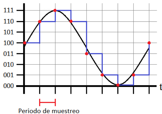
Figura 47: Digitalización de una onda con profundidad de 3 bits y periodo de muestreo igual a 1/8 el periodo de la onda
