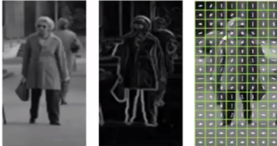
Figura 2.6. Gradientes e histogramas de una imagen: Izquierda) Imagen original, Centro) Gradientes de la imagen, Derecha) Histograma de Gradientes Orientados (Ramos, 2016).
