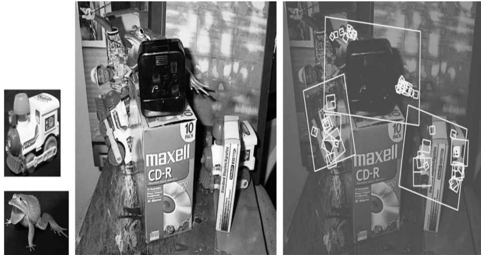
Figura 2.7. Izquierda) Dos imágenes de objetos a buscar. Centro) Imagen de prueba con mucha oclusión. Derecha) Resultado de SIFT. El rectángulo dibujado muestra la ubicación de los objetos a buscar, y los pequeños cuadros indican los puntos clave que son usados para el reconocimiento (Lowe, 2004).
