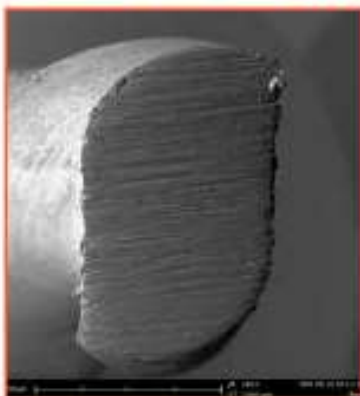
Sección transversal en forma de S
