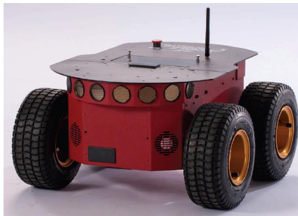
Figura 34. Plataforma robótica de desarrollo inteligente llamada PIONEER 3-AT en cual se basa la investigación para implementar el sistema de barrido por láser y el sistema de navegación.
