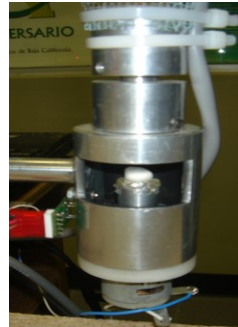
Figura 12. Apertura de Escaneo, SA en el TVS
