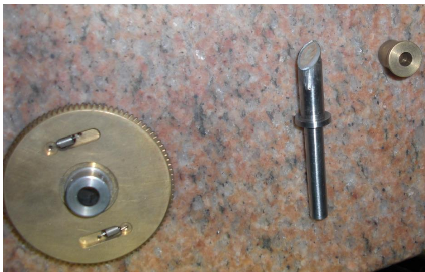
Engrane anti-juego, flecha con espejo corte 45° y guía de la flecha
