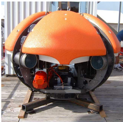
Figura 2. Robot DEPTHX, proyecto realizado por la Universidad Carnegie Mellon , su objetivo es generar un mapa digital de la zona del cenote Zacatón en México.
