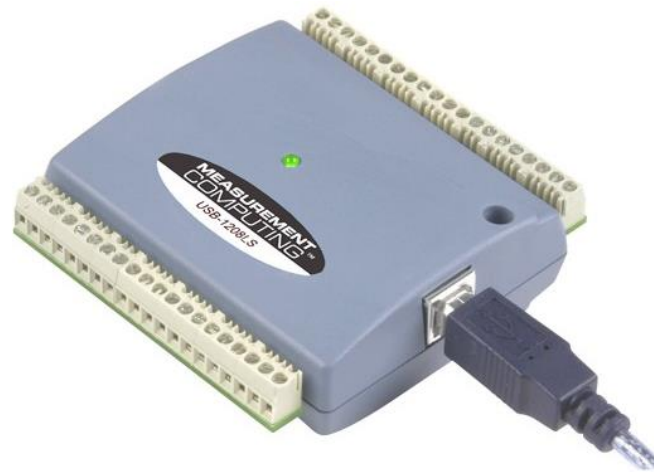
Figura 12. Sistema de adquisición de datos MC DAQ USB-1208LS utilizado para comunicar la computadora con el resto de la circuitería del sistema de barrido.
