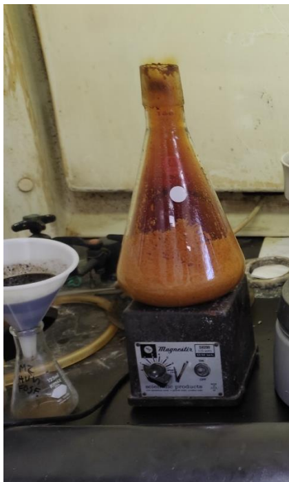
Figura 9. Imagen de la modificación química del bagazo residual con ácido nítrico concentrado.
