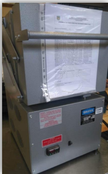
Figura 3.18 Horno para térmico para tratamiento de metales C1228/PM4.
