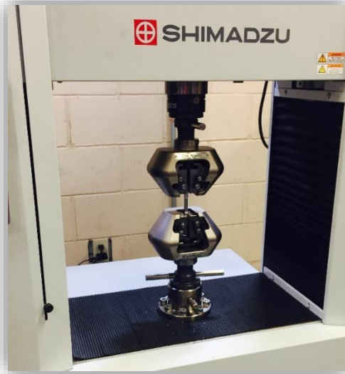
Figura 3.22 Máquina Universal de Ensayos Mecánicos SHIMADZU aplicando fuerza a probeta.
