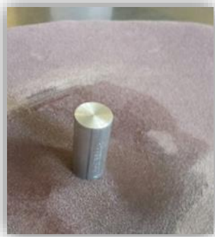
Figura 3.13 Muestra en proceso de pulido.
