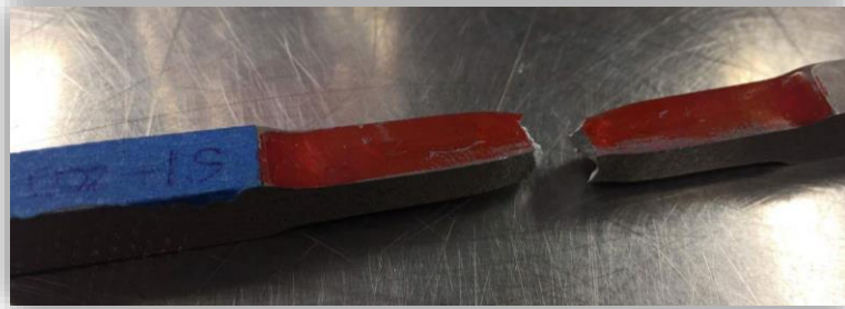
Figura 3.24 Cara lateral de muestra A13 después del ensayo de tensión.
