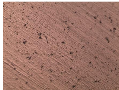
50X Muestra atacada químicamente con HF al 5%
