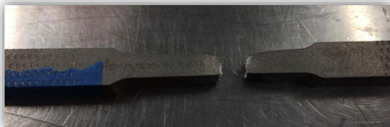
Figura 3.25 Cara trasera de muestra A13 después del ensayo de tensión.
