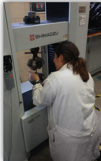
Figura 3.21 Colocación de probeta en Máquina Universal de Ensayos Mecánicos SHIMADZU.
