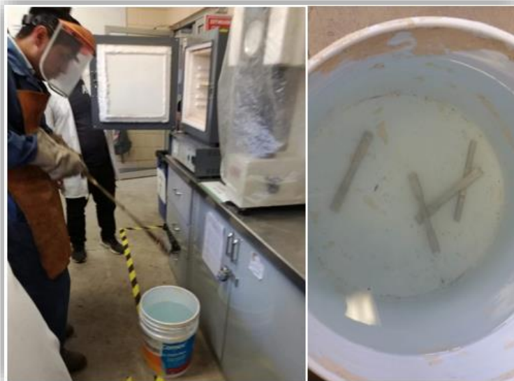
Figura 3.19 Muestras pasando del horno al recipiente con agua para realizar el enfriamiento rápido.
