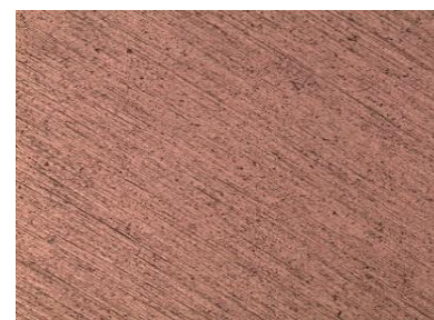
10X muestra atacada químicamente con HF al 5%
