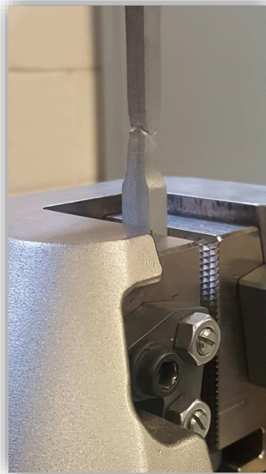
Figura 3.23 Probeta con deformación plástica aun en mordazas de la Shimadzu.
