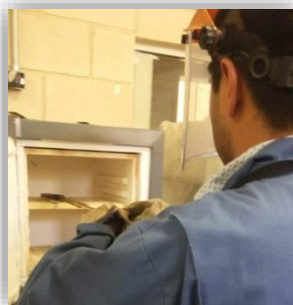
Figura 3.20. Muestras después del normalizado introducidas nuevamente al horno para realizar el tratamiento de envejecido.
