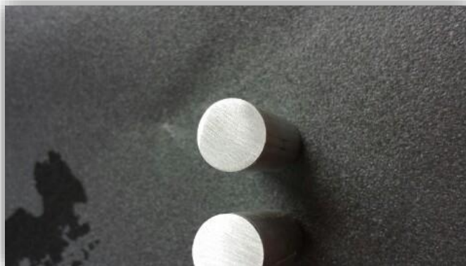
Figura 3.12 Superficie desgastada de ambas muestras, finalización de lijado.
