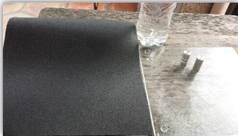
Figura 3.10 Material necesario para el desgaste de las muestras. Lijas del número 400 al 2000, agua potable y base de vidrio.
