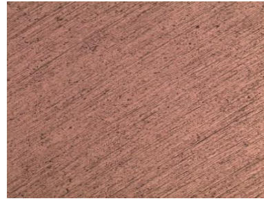
10X muestra atacada químicamente con HF al 5%
