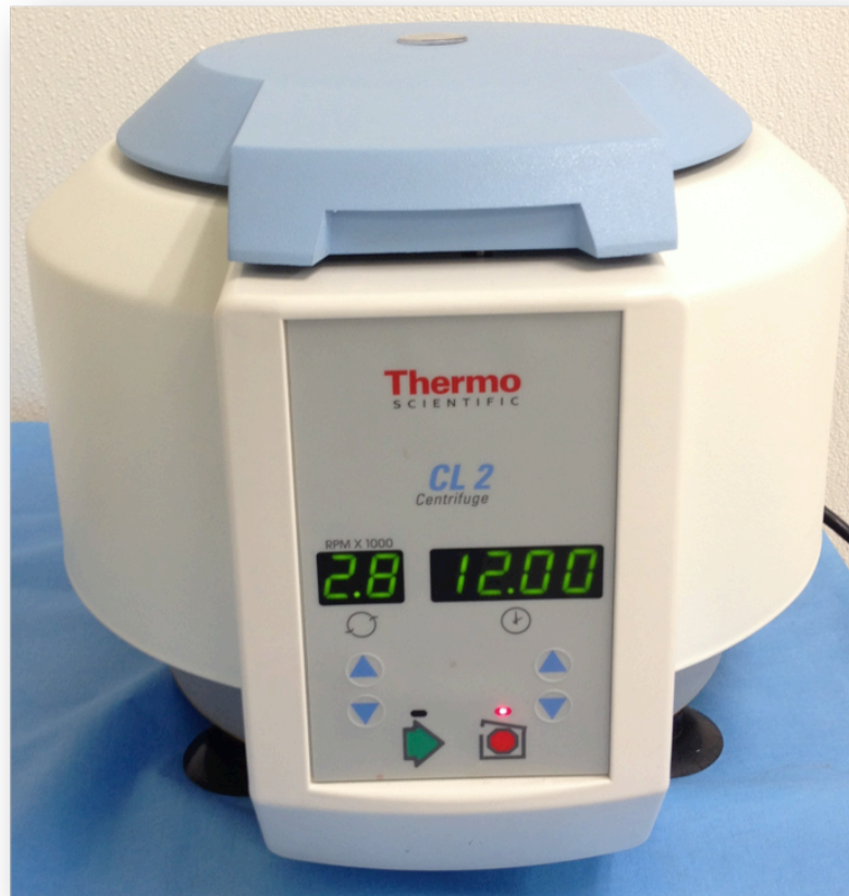
Fig. 5 Centrífuga Thermo Scientific CL 2, 3.8 x 1000 RPM por 3 min.
