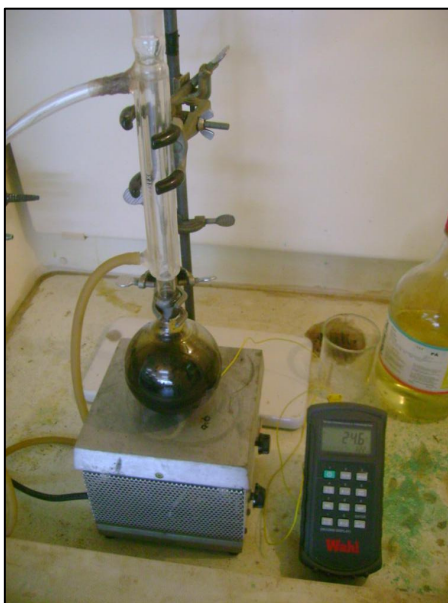
Figura 4.3 Arreglo de Sistema para Reflujo de \text{HNO}_3
