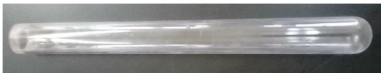
Fig. 7. Tubo de cuarzo utilizado para la síntesis de compósitos.
