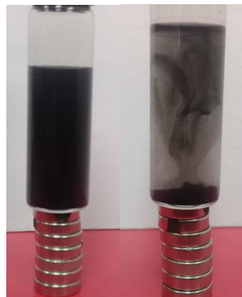
Fig. 12. Prueba magnética en medio acuoso (isopropanol).
