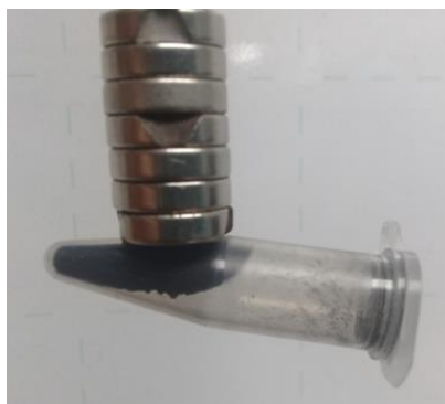
Fig. 11. Atracción magnética entre compuesto M3 con imanes de neodimio.
