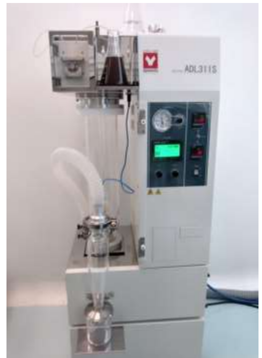
Figura 11. Tratamiento colocado en el equipo de secado por aspersión.
