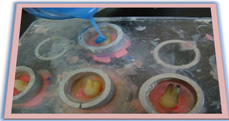
Fig. 6 Llenado de los aros metálicos con acrílico.
