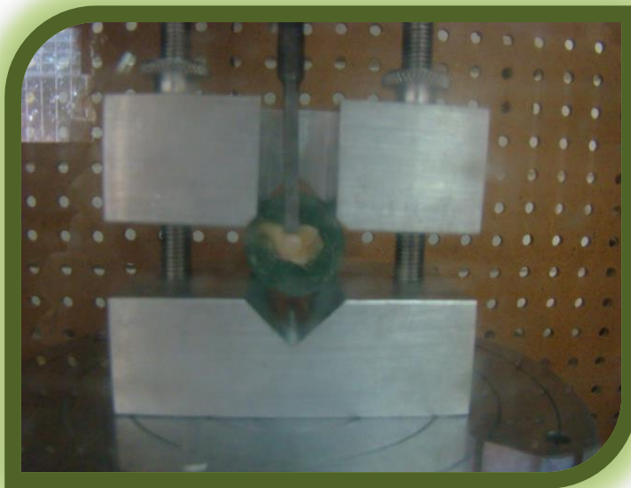
Fig. 42 Se aplicó la prueba de desprendimiento a la totalidad de la muestra.
