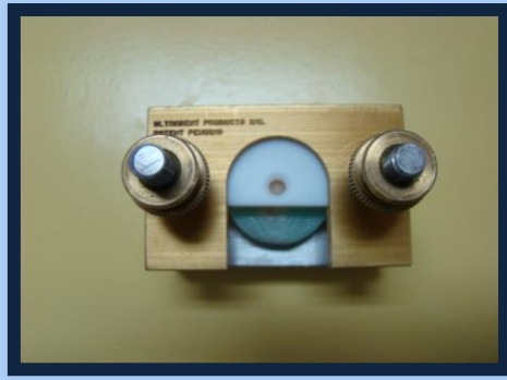
Fig. 27 La muestra está lista para recibir el botón de resina.
