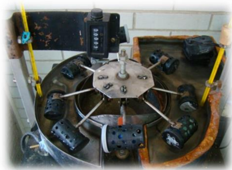
Fig. 37 Se termocicló la totalidad de la muestra durante 500 ciclos.
