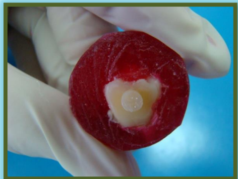
Fig. 34 El botón de resina queda justo en el centro de la dentina.
