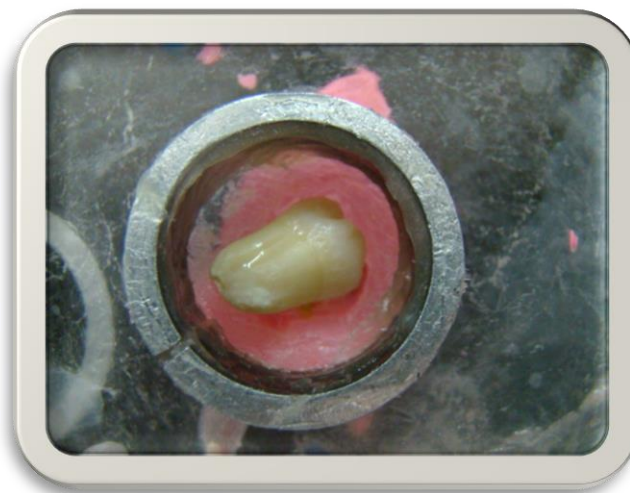
Fig. 5 El aro de metal rodea la circunferencia de acrílico que contiene al molar.
