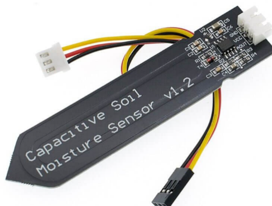
Figura 2.2 Sensor SEN-HS-CAP. Fuente: UElectronics, 2024.
