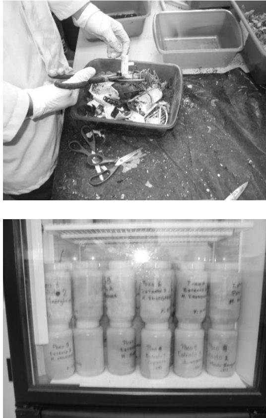
Figura 6. Reducción manual de los componentes de las muestras y refrigeración de éstas.
