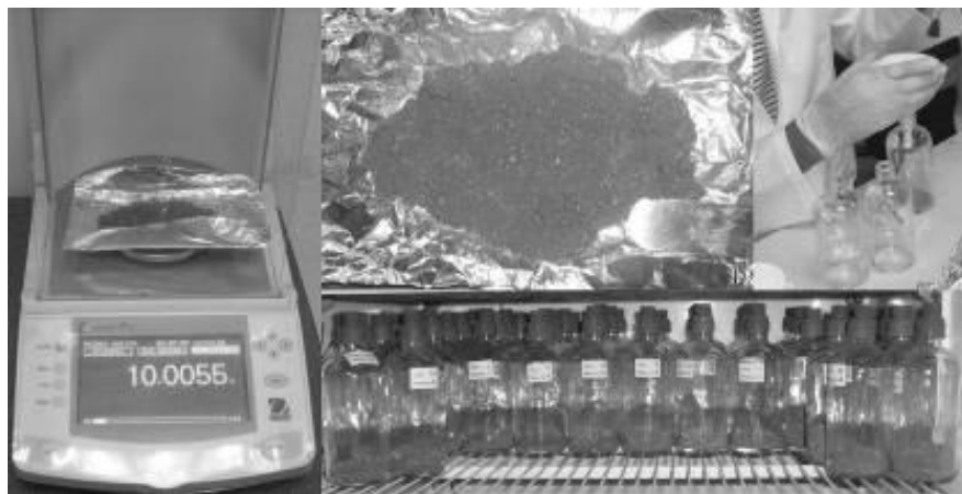
Fig. 10. Montaje de la prueba de Potencial Bioquímico de Metano.
