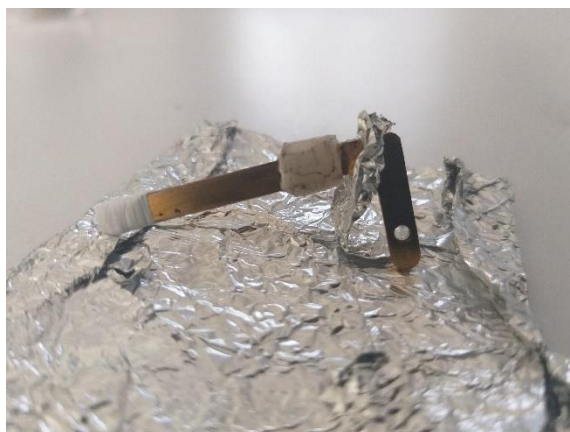
Figura 37. Electrodo de oro utilizado como electrodo de trabajo en los ensayos de VC.
