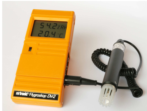
Figura 2.4: Medidor de humedad relativa.
