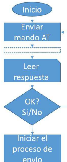
Figura 3.15: Diagrama de flujo de la comunicación entre el Arduino y el SIM900.
