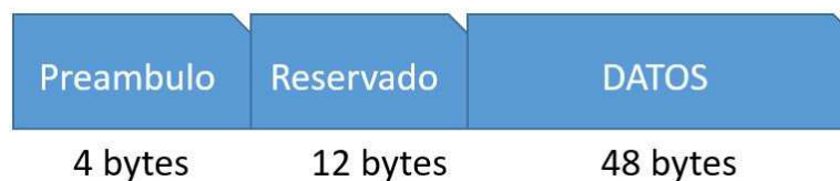
Figura 3.35: Trama general del sistema de comunicación.
