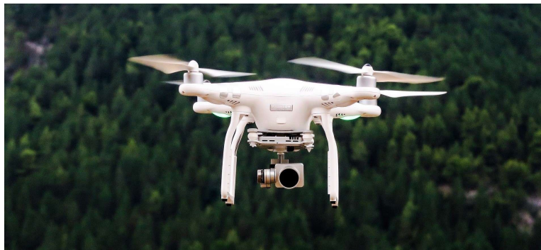
Figura 1.1: Cuadricóptero utilizado en tarea de inspección.
