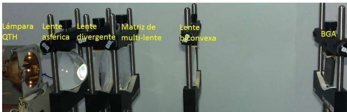
Figura 5.3. Fotografía del arreglo óptico con una matriz de multi-lentes para FILSS.
