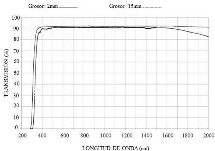
Figura 4.14. Ventana de transmisión del material B270.
