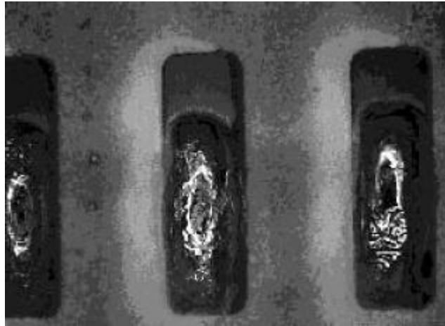
Figura 2.24. Ejemplo de una no fundición de la soldadura, mostrada por la exposición de los pads de cobre [2].
