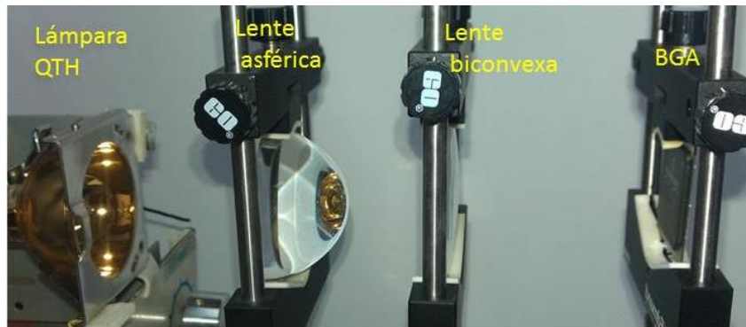
Figura 5.1. Fotografía del arreglo básico para FILSS.
