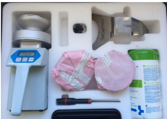
Figura 6. Muestreador de aire M air T. 1000 micro-perforaciones Capacidad: 1000L (35ft 3 ) Flujo de aire: 140L/min para los primeros 500L Después 180L/min Máxima capacidad: 1000L en menos de 7 minutos
