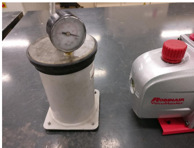
Figura 3.34. Trampa de resina con manómetro de presión y bomba de vacío.
