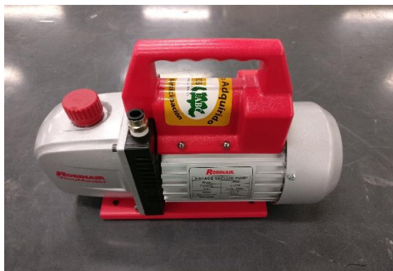
Figura 3.4.- Bomba de vacío entregada por el fabricante.
