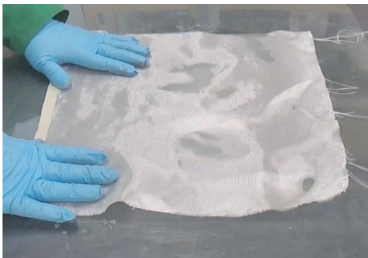
Figura 3.26. Primera capa de fibra de vidrio.
