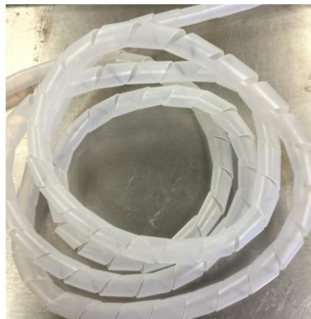
Figura 3.11.- Tubería en espiral utilizada para permitir un mayor flujo de resina.
