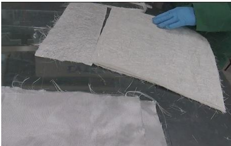
Figura 3.43. Recorte de fibra de vidrio.
