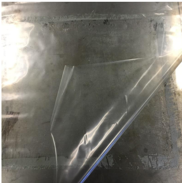
Figura 3.25. Bolsa de aislamiento.
