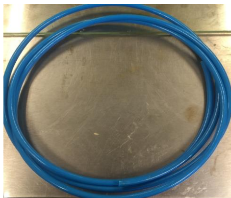
Figura 3.6.- Tubería de PVC para aspiración de resina.
