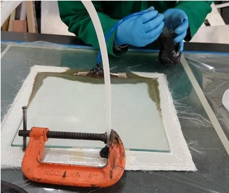
Figura 3.51. Infusión de resina por medio de bomba de vacío.
