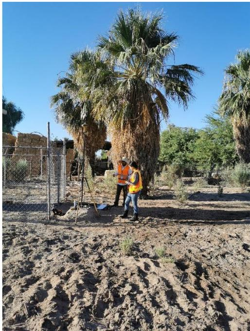
**Figura 16** Colocación de antena en el pozo.
