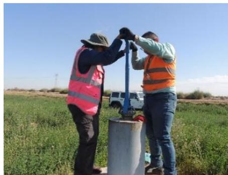
**Figura 22** *Medición de la profundidad al nivel estático.*
