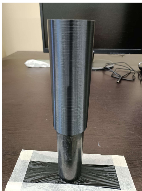
Figura 5-7: Colocación de la fixtura para núcleos.
