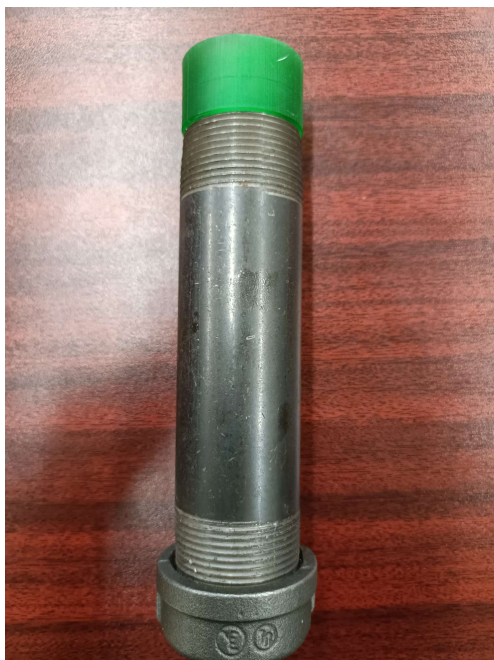
Figura 6-3: Referencia de motor con tobera impresa ensamblado (sin mecha).
