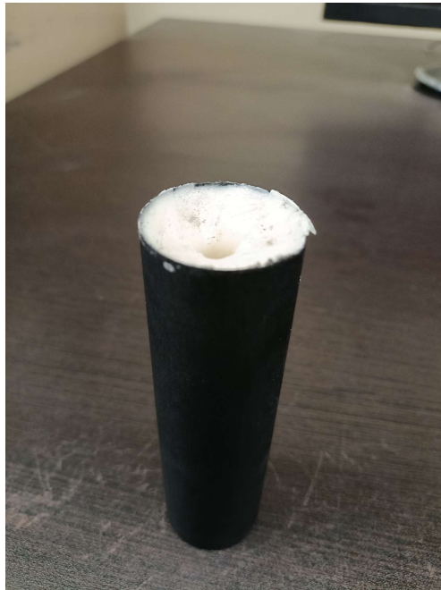
Figura 5-10: Grano de propelente KNSB.
