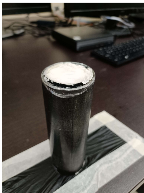
Figura 5-5: Molde lleno de propelente KNSB.
