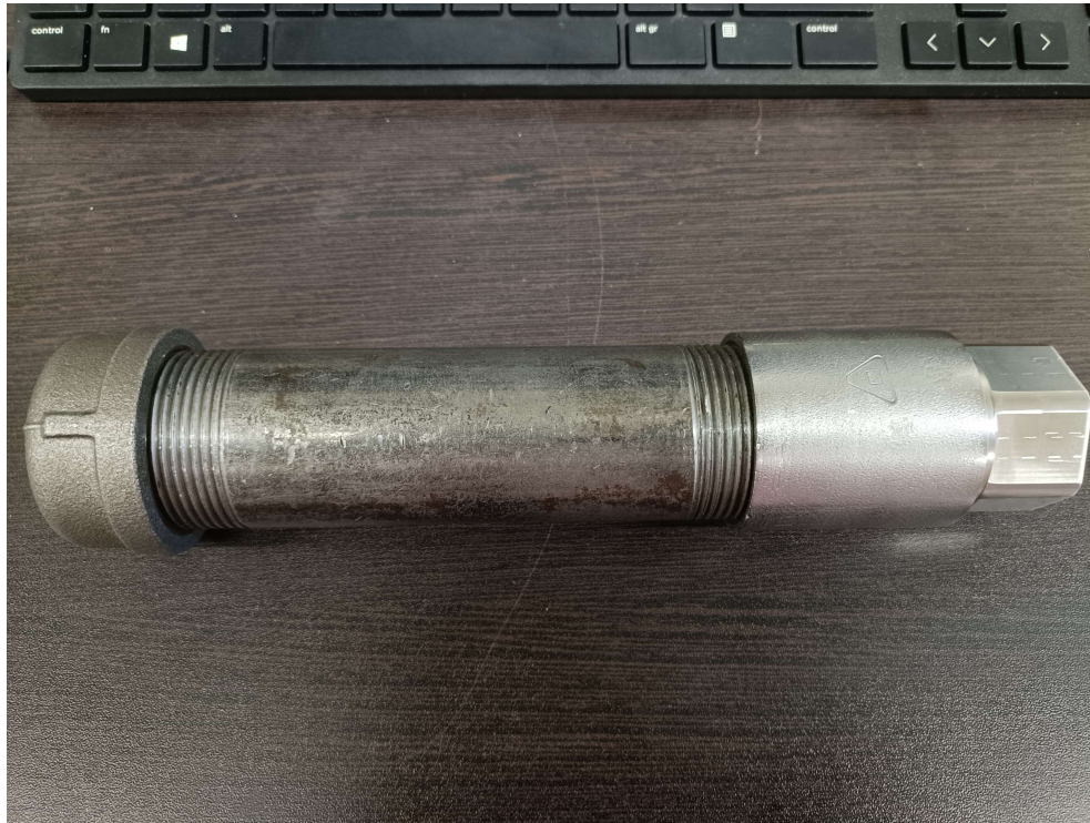
Figura 6-4: Referencia de motor con tobera maquinada ensamblado (sin mecha).
