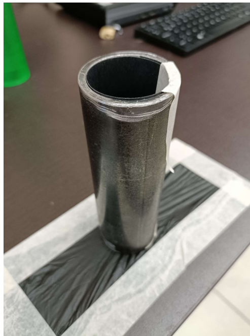
Figura 5-4: Colocación del molde para fundición.
