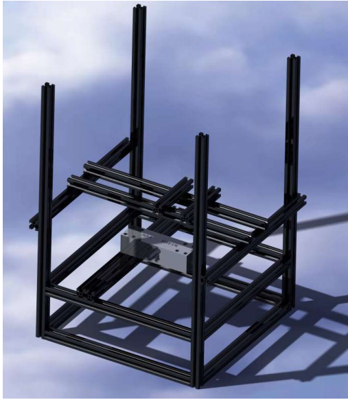
(a) Diseño renderizado del banco de pruebas.
