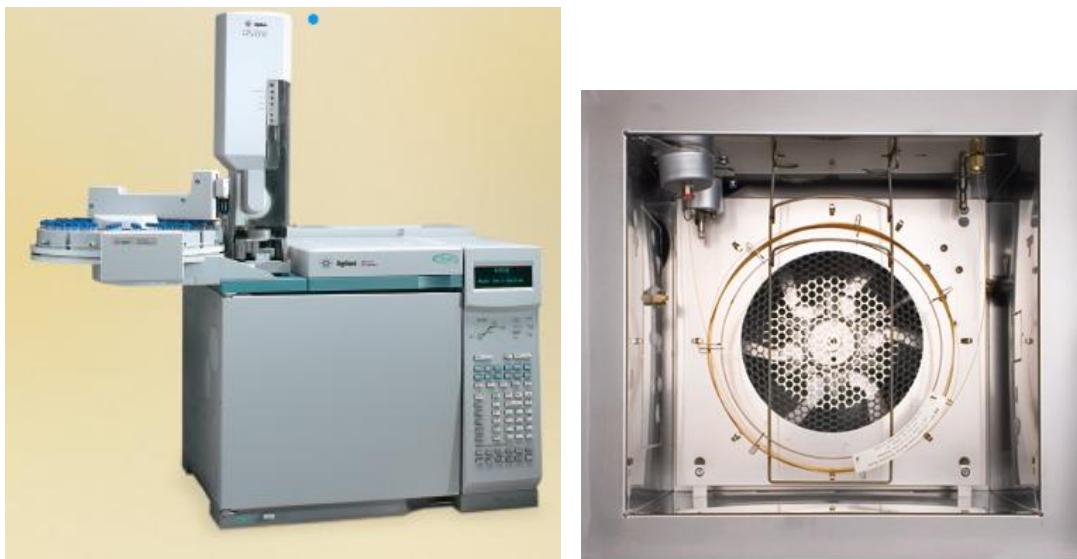
Figura 10. Configuración típica de un cromatógrafo de gases.
