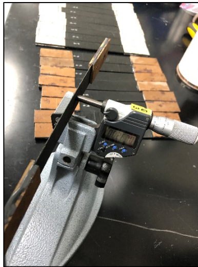
Figura 87. Medición de espesor de probeta con micrómetro.
