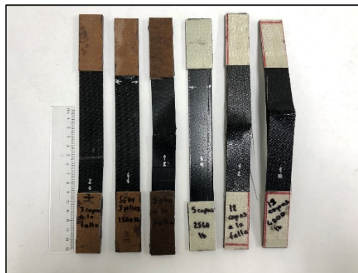
Figura 104. Especímenes seleccionados para evaluación microscópica.
