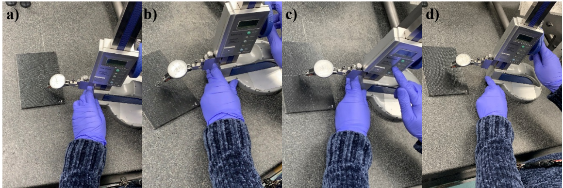
Figura 58. Medición de daño con altímetro en 4 zonas distintas para realizar cálculo de profundidad, a) toma de altura cero a 270^\circ de la zona de impacto, b) toma de 1er lectura de mayor profundidad, c) toma de altura cero a 0^\circ de la zona de impacto, d) toma de 2da lectura de mayor profundidad.
