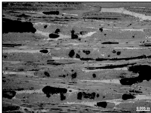
Figura 49. Se muestra la sección transversal de la probeta 13 de 12 capas, la cual presentó un esfuerzo máximo de 460.064 lbf, debido a que a este esfuerzo la prueba fue programada para detener la aplicación de carga. Por este método de evaluación, no fueron encontradas fibras seccionadas en la zona crítica de aplicación de carga del rodillo central.
