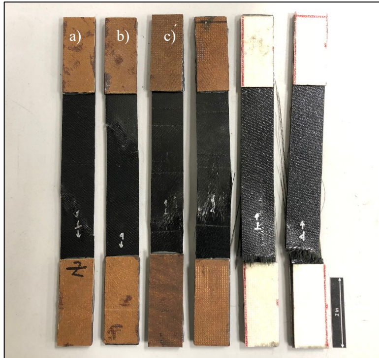
Figura 131. Probetas de SBS seleccionadas al azar para evaluación de contenido de resina. a) Probeta 1 de 3 capas, b) Probeta 4 de 3 capas, c) probeta 1 de 5 capas, y continúa sucesivamente.
