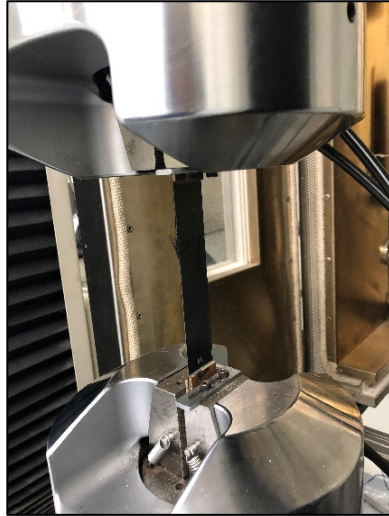
Figura 88. Sujeción de probeta con las mordazas neumáticas.
