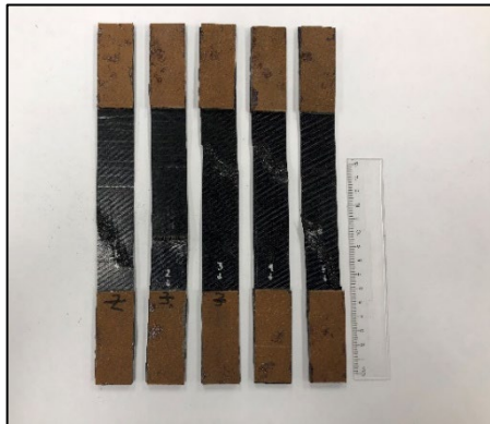
Figura 89. 5 especímenes de 3 capas con pestañas de fibra de vidrio y poliamida fueron sometidos a esfuerzos de tensión hasta la falla con una presión de sujeción en mordazas de 250 psi.
