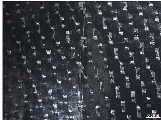
Figura 32. Probeta 3 de 3 capas, en zona convexa (sin contacto con rodillo central), mostrando fisuras a lo largo de la zona central.
