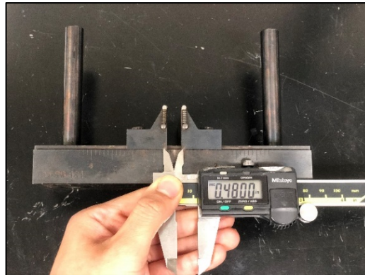
Figura 22. Longitud indicada con vernier entre 2 rodillos fijos, obteniendo un valor de “span” 1.22 cm [0.4800 in].
