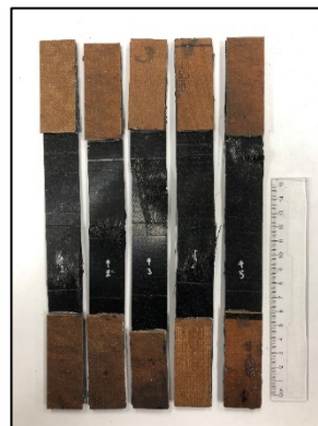
Figura 94. 5 especímenes de 5 capas con pestañas de fibra de vidrio y poliamida, fueron sometidos a esfuerzos de tensión hasta la falla con una presión de sujeción en mordazas de 350 psi.
