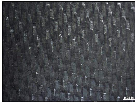
Figura 34. Probeta 13 de 3 capas, en zona inferior (sin contacto con rodillo central), no presentó fisuras según la inspección visual.
