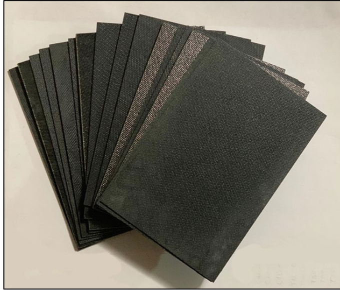
Figura 54. Probetas ASTM D7136 fabricadas de material compuesto de fibra de vidrio con resina fenólica.
