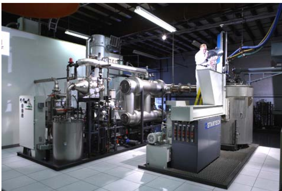
Figura 2-8. Planta tratadora de residuos por plasma "Slim-fast" de Startech.
